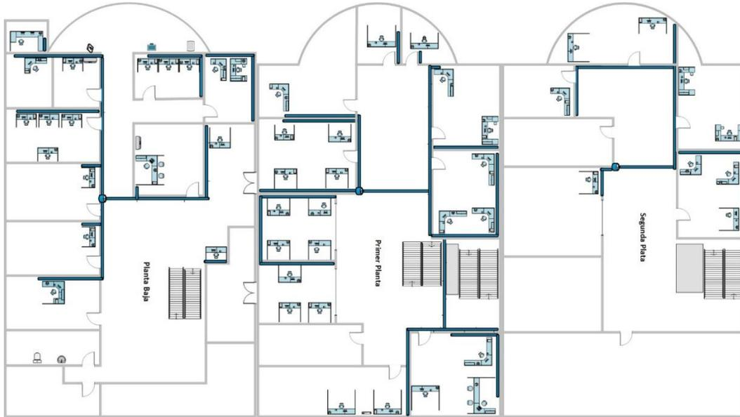
*Figura 54. Cableado físico de planta baja, primer y segunda planta*
