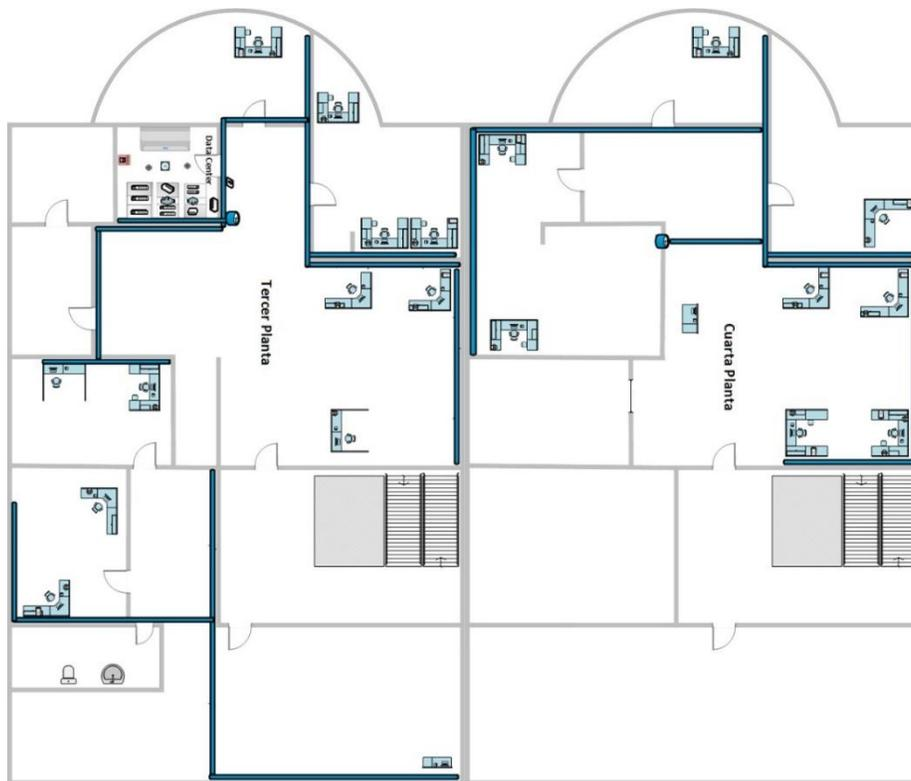
*Figura 55. Cableado físico de tercer y cuarta planta.*
