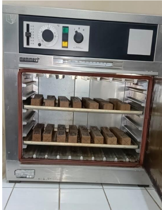
Probetas puestas en la estufa.
