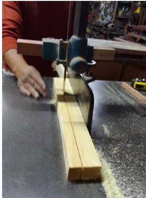
Corte de las probetas en el aserradero.
