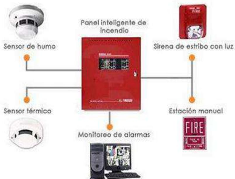
*Figura 117. Sistema de detección de incendios*
