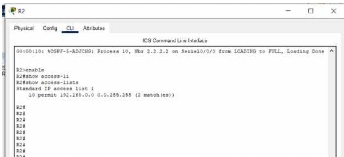
*Figura 85: Prueba de asignación de ACL para el acceso a internet en el router*
