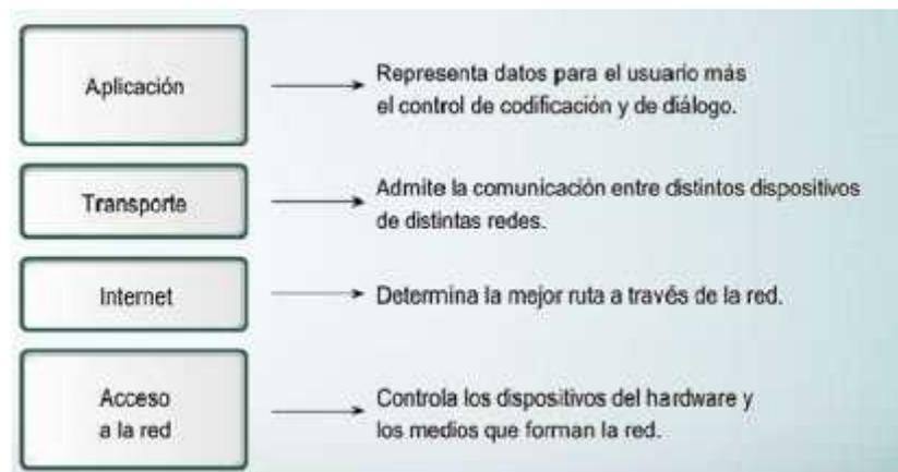
*Figura 4: Modelo TCP/IP*
