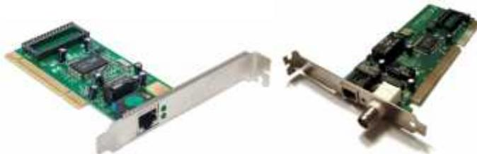
*Figura 12: Tarjeta de red PCI*
