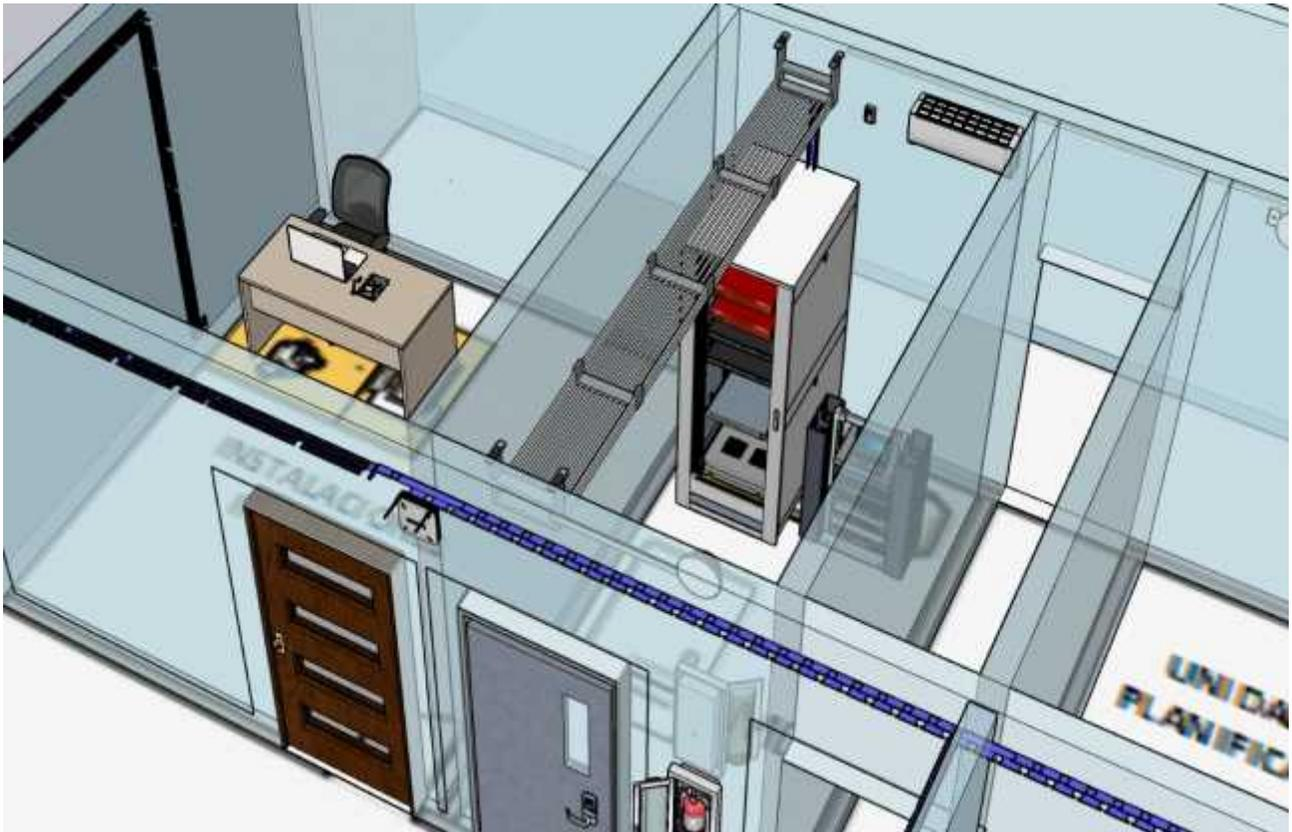
*Figura 40: Diseño del MDF del primer piso, vista 3D*
