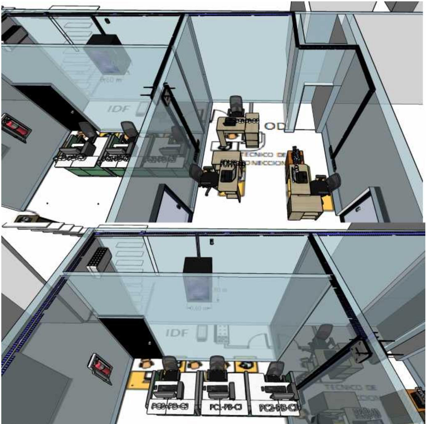
Figura 38: Diseño del cableado UTP de la planta baja, vista 3D
