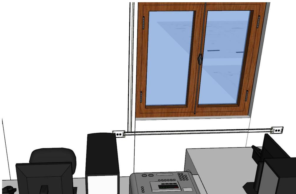
**Figura III.1.57:** Simulación de rosetas y canaletas en Scketchup
