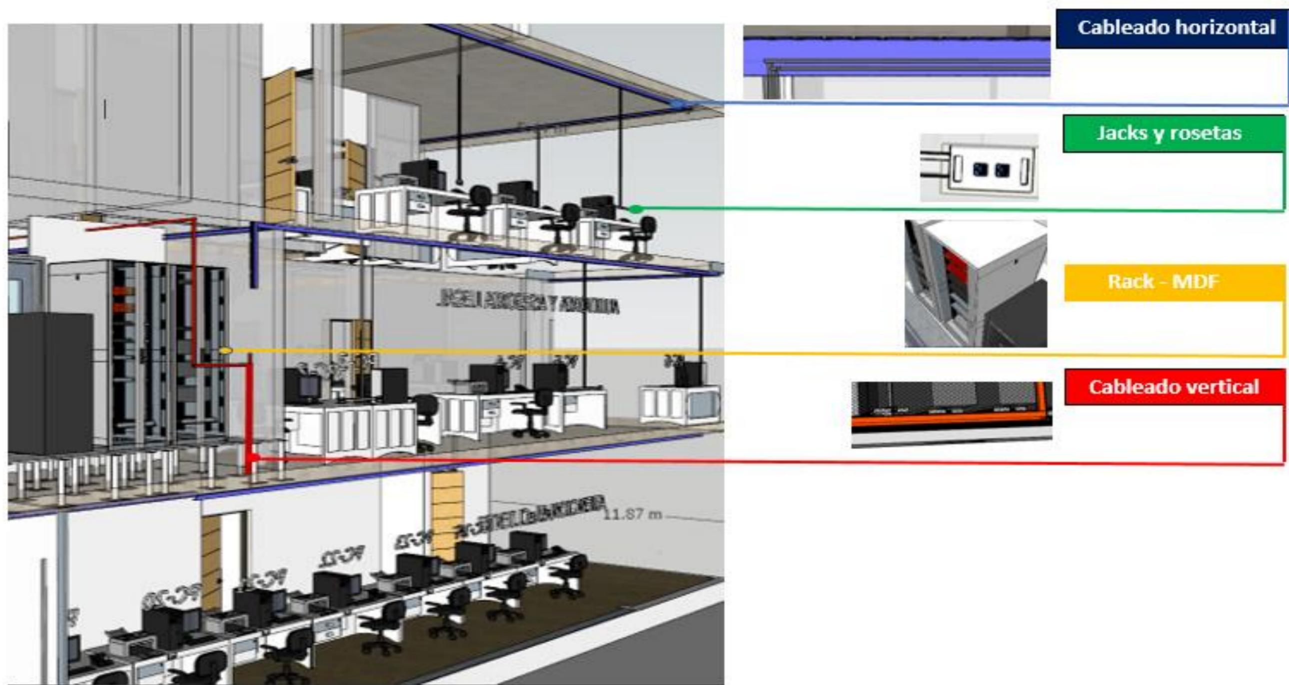
Figura A.1.1: Diagrama de cableado horizontal y vertical
