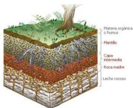
Suelo Eluvial, es un depósito de fragmentos de una roca, desagregados por los agentes atmosféricos, que han permanecido in situ o muy próximos a la roca madre.
