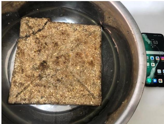
Ilustración 99 Biomaterial Aislante sumergido en agua después de diez horas. Fuente: Elaboración propia.
