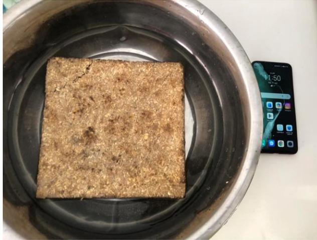
Ilustración 98 Biomaterial Aislante sumergido en agua. Fuente: Elaboración propia.
