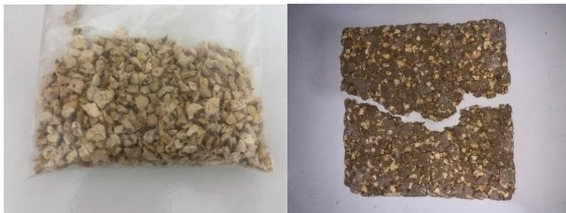
Ilustración 56 Prototipo fallido gramaje 8mm a 4mm. Fuente: Elaboración propia.
