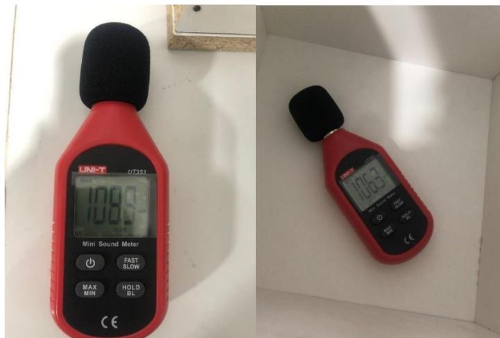
Ilustración 70 Medición con sonómetro caja de melamina. Fuente: Elaboración propia.
