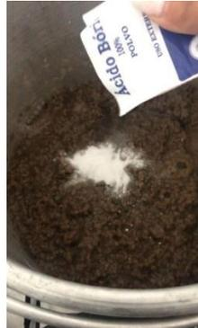
Ilustración 36 Celulosa de cartón tratado con ácido bórico. Fuente: Elaboración propia.
