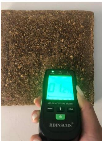
Ilustración 78 Medición humedad del prototipo A. Fuente: Elaboración propia
