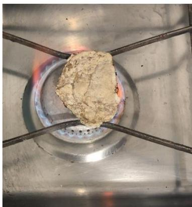
Ilustración 63 Prueba del aglomerante final al fuego. Fuente: Elaboración propia.
