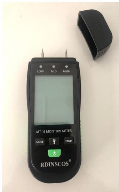
Ilustración 20 Higrómetro digital. Fuente: Elaboración propia
