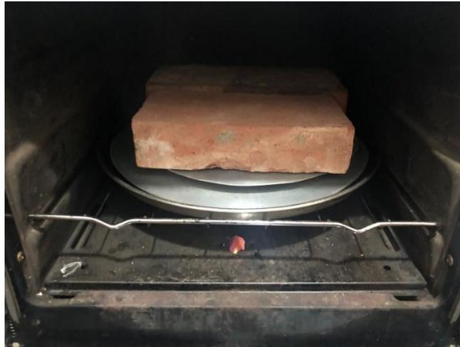
Ilustración 47 Secado en horno de cocina. Fuente: Elaboración propia.
