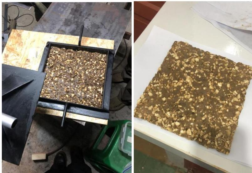
Ilustración 45 Moldaje a presión manual. Fuente: Elaboración propia.
