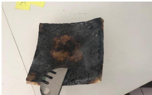
Ilustración 85 Resultado exposición al fuego prototipo A. Fuente: Elaboración propia
