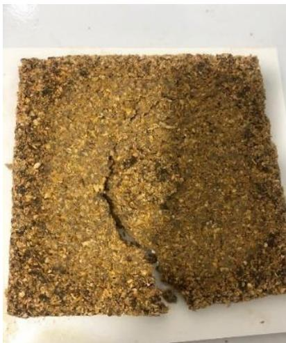
Ilustración 57 Prototipo fallido con solo celulosa de cartón. Fuente: Elaboración propia.
