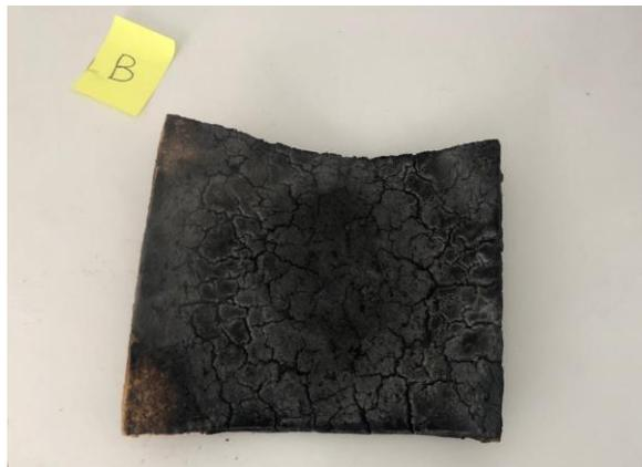
Ilustración 89 Resultado exposición al fuego prototipo B. Fuente: Elaboración propia
