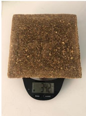
Ilustración 80 Masa del prototipo A. Fuente: Elaboración propia.
