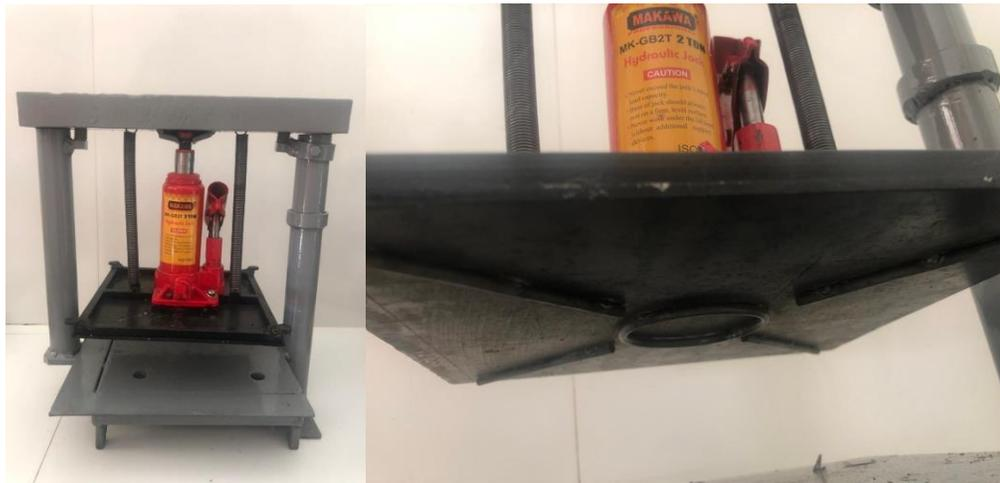
Ilustración 50 Prensa con gato hidráulico. Fuente: Elaboración propia.
