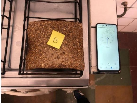
Ilustración 88 Exposición al fuego prolongada prototipo B. Fuente: Elaboración propia.
