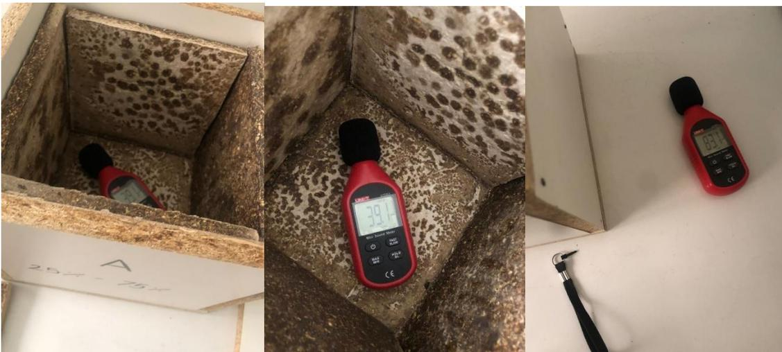
Ilustración 76 Medición con sonómetro dentro y fuera prototipo A. Fuente: Elaboración propia.
