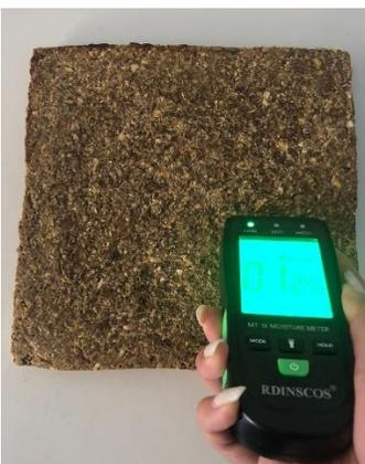
Ilustración 79 Medición humedad del prototipo B. Fuente: Elaboración propia.
