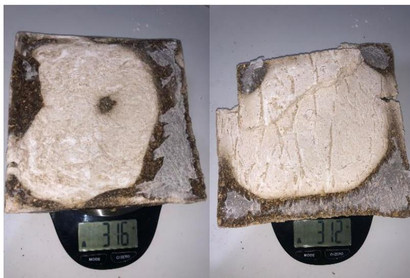
Ilustración 61 Masas de prototipos A y B secados al sol. Fuente: Elaboración propia.
