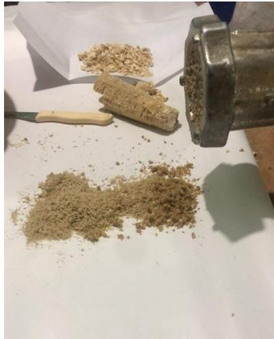
Ilustración 30 Triturado con molino de grano manual. Fuente: Elaboración propia.
