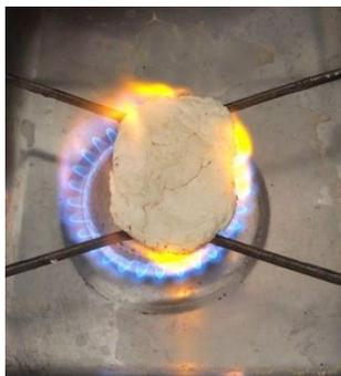
Ilustración 62 Prueba al fuego Starlite. Fuente: Elaboración propia.
