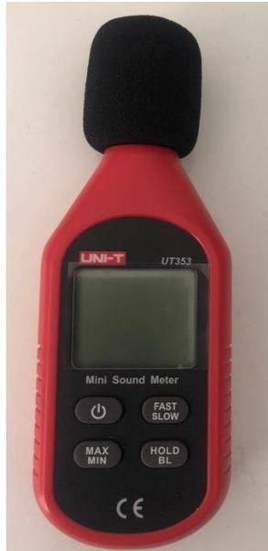
Ilustración 19 Sonómetro digital. Fuente: Elaboración propia
