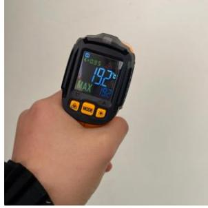
Un muro exterior tiene una temperatura de 28,4°C y el mismo muro en el interior arroja una temperatura de 19,2°C, lo cual da una variación de 9,2°C entre el exterior e interior.
