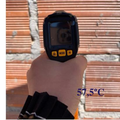
AL COMPARAR LOS DATOS DE LA TEMPERATURA DE UN MURO DE LADRILLO REVOCADO Y PINTADO Y OTRO SIN REVOQUER, SE VE QUE UNA DIFERENCIA DE TEMPERATURA DE UN 13,9°C MAS CALIENTE EL MURO SIN REVESTIMIENTO.
