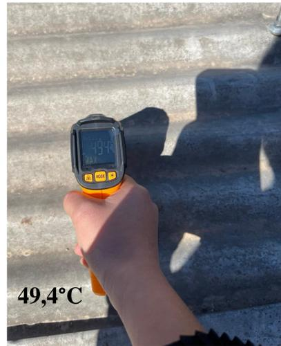
UNA CUBIERTA DE CALAMINA ES MAS CALIENTE QUE UNA LOSA DE HORMIGÓN CON UNA DIFERENCIA DE 8,3°C ESTOS DATOS SON OBTENIDOS A LAS 12:00PM. DONDE LE DIO LOS RAYOS DE SOL
