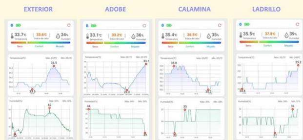
EN LAS VARIACIONES SE OBSERVA QUE EL MATERIAL MAS IDONEO ES EL ADOBE Y EL MATERIAL QUE MAS ABSORBE CALOR Y ES MENOS CONFORTABLE ES EL DE UNA VIVIENDA CON CUBIERTA DE CALAMINA Y MURO DE LADRILLO
