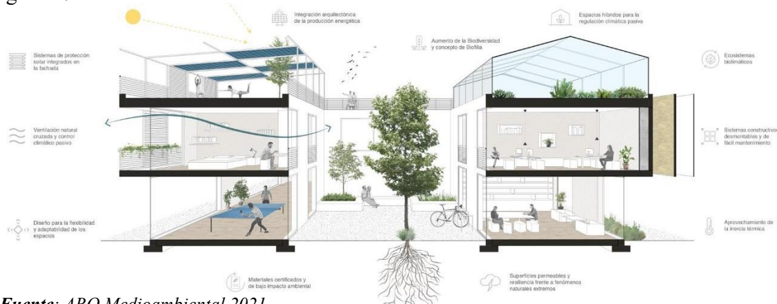
Figura 47 Detalle Del Sistema De Ventilación
