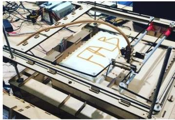
**Ilustración 27.** Cortadoras y Grabadoras Laser de ensamblaje propio
