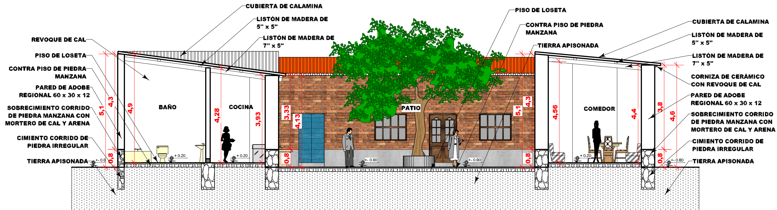
Esc.1:100 CORTE FACHADA A-A'
