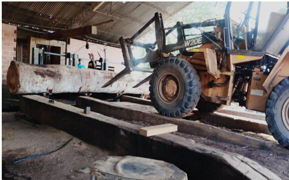
Anexo 19. Pala abasteciendo la rampla con las troncas que seran sujetas a proceso de aserrado
