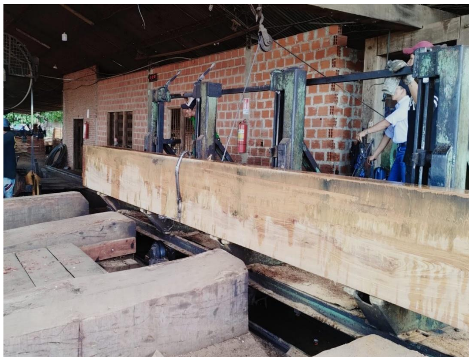
Anexo 25. Carro porta troncas- guinchado de la tronca en proceso de corte.
