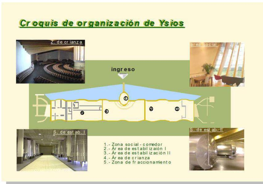
los delestages y remontados; depósitos horizontales para la estabilización en frío; depósitos de tipificación que homogenizan los lotes; un parque de barricas.
