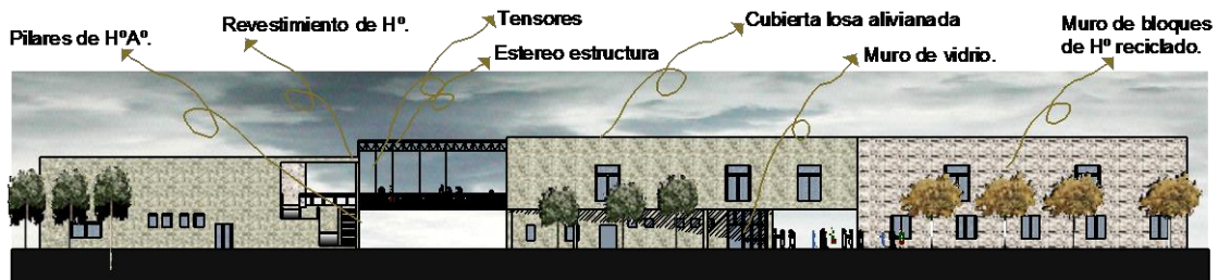
FACHADA LATERAL IZQUIERDO__Bloques "B" y "C".
