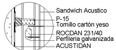
DETALLE DE SUJECCION LATERAL
