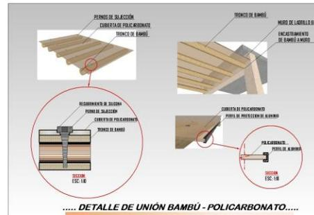
..... DETALLE DE UNIÓN BAMBÚ - POLICARBONATO .....
