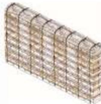
Paso 6. Amarre de drizas horizontal y vertical con driza transversal. Finalmente amarrar las drizas transversales con las drizas horizontales y verticales mediante un nudo doble.
