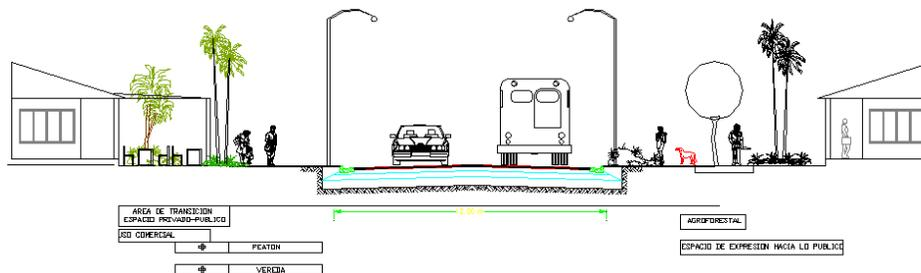
**Corte transversal de vía #2: Perfil de vía con alternativas de transformación de espacios (aplicación de retiros y normativas)**
