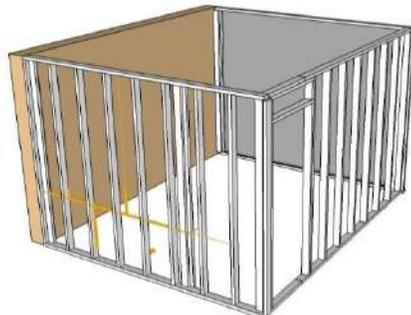
Ilustración 121 Steel Framing
