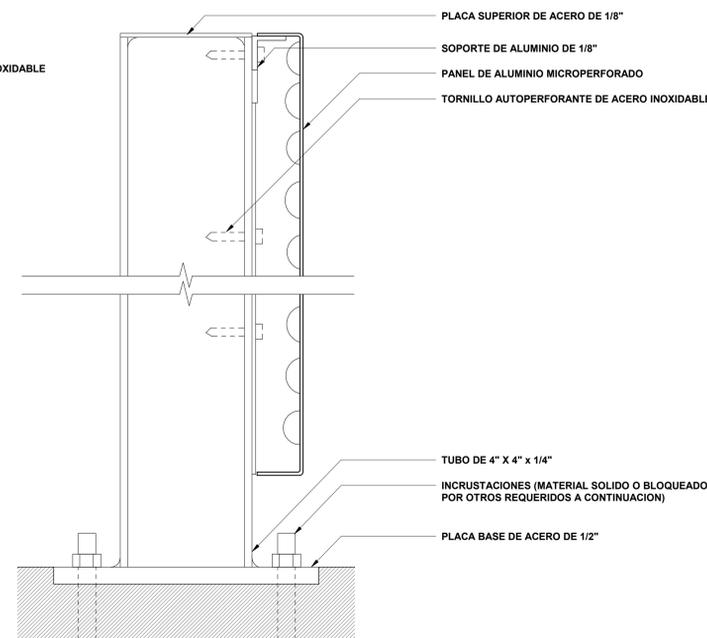
DETALLE DE SECCION - ESC. 1:2
