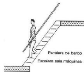
4 Escaleras a la molinera con barandilla
