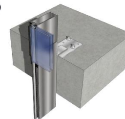
DETALLE DE ANCLAJE DE MURO DE CORTINA
