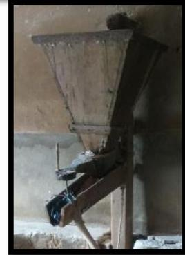
5.- De la canaleta el maíz cae en una boquilla que introduce lo introduce y distribuye dentro de la piedra con ayuda de unas aspas metálicas.
