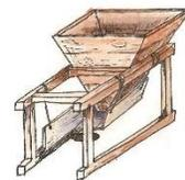
8. Guardapolvo, cajón, costanera. Estuche cilíndrico o poligonal que cubre las muelas.
