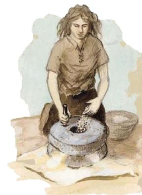
Se trata de molinos rotatorios, de diferentes tamaños y tipologías, que utilizan como energía motriz la “tracción de sangre” de un ser vivo. Están formados por una base o piedra y una parte superior rotatoria o móvil, colocada sobre la anterior, atravesada de arriba abajo por un orificio central por el que circula el grano para ser molido.
