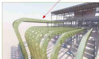
SISTEMA ESTRUCTURAL SALA DE HIDROTERAPIA (PISCINA).- Estructura Metálica (serchas) armadura en 'V'.
