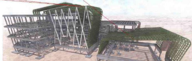
SISTEMA ESTRUCTURAL INGRESO PRINCIPAL.- Estructura Metálica (serchas), armadura en 'V'.
