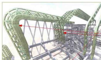
SISTEMA ESTRUCTURAL INGRESO PRINCIPAL.- Estructura Metálica (serchas), armadura en 'V'.
