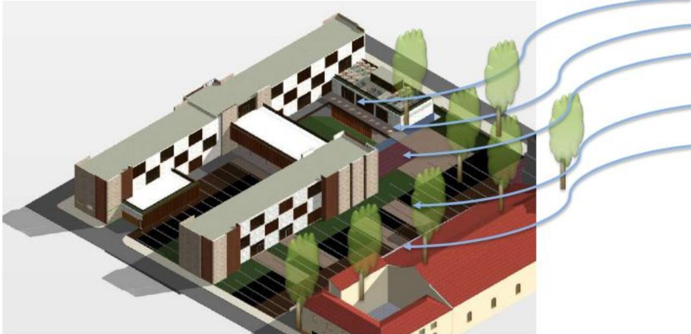
Las fachadas controlan la velocidad del viento mediante la celosía y las ventanas tipo parasoles y la vegetación exterior así disminuyendo la probabilidad de fuertes vientos incrementando la confortabilidad ambiental en todos los espacios.
