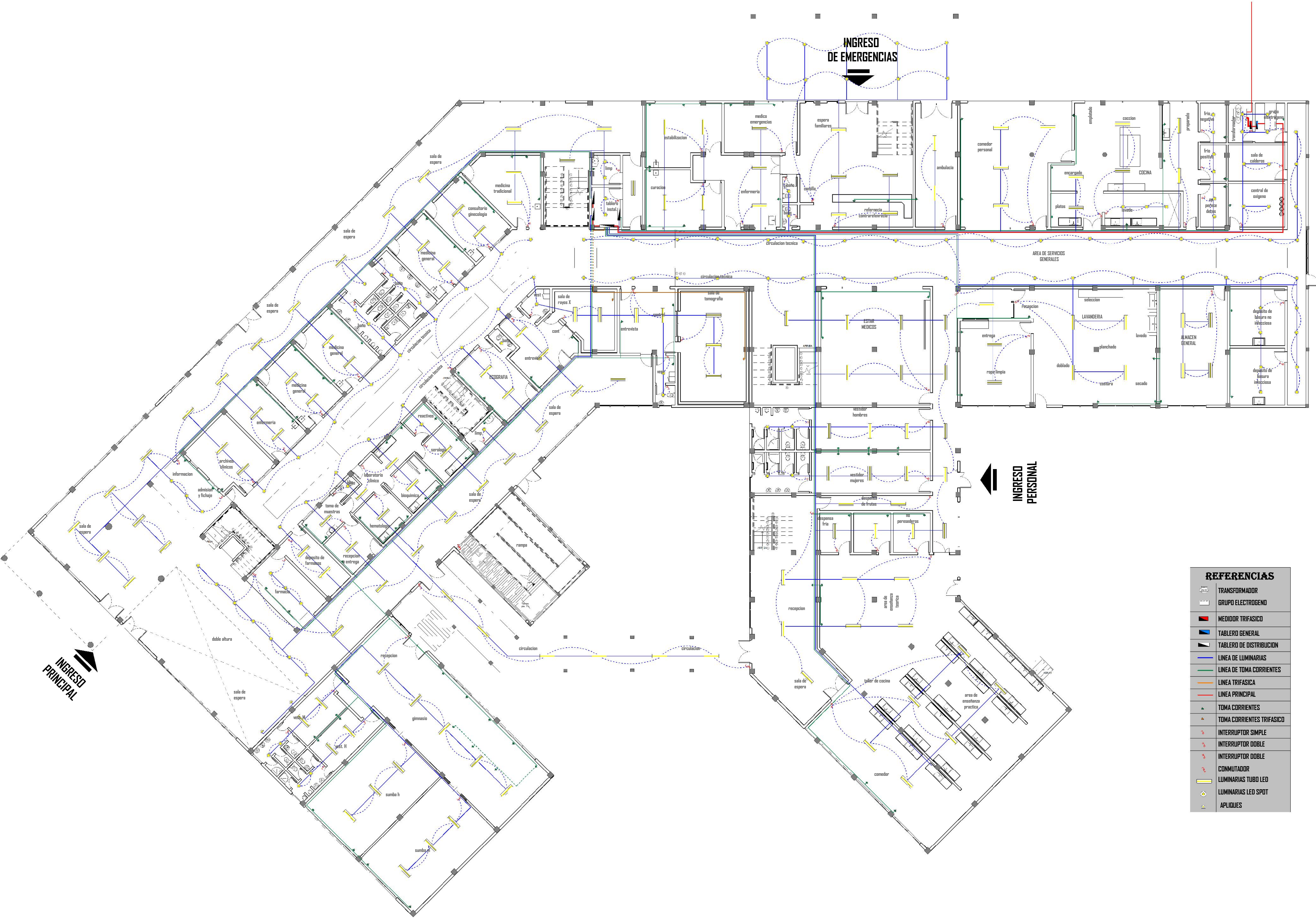
PLANTA BAJA INST. ELECTRICA ESC. 1:150
