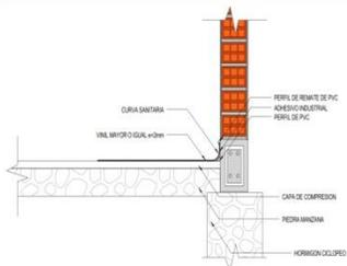
**FIGURA DE VINIL Y CUBIERTA SANITARIA ESC: 1:10**
