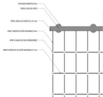
**FIGURA DE ESTRUCTURA DE MALLA METALICA ESC: 1:10**
