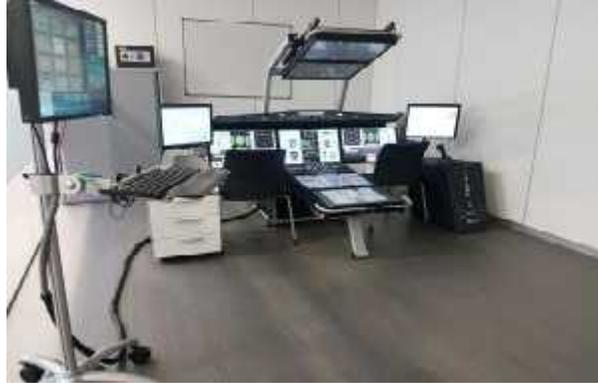
Es un acercamiento al mundo virtual en el aeródromo, viene equipado con monitores LCD de 22 pulgadas para tener una visión panorámica, con mandos de vuelo y palancas, muestra el realismo en vuelo de una manera visual
