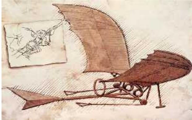
Sus esquemas, sin embargo, como el del **ornitóptero**, que falló al momento de ser puesto en práctica. Las máquinas de aleteo que había diseñado eran muy pequeñas para elevarse lo suficiente, en algunos casos, o muy pesadas para ser operadas por humanos. A pesar de que el ornitóptero sigue siendo un tema de interés para ciertos grupos de aficionados, este instrumento fue reemplazado por el planeador en el siglo XIX.
