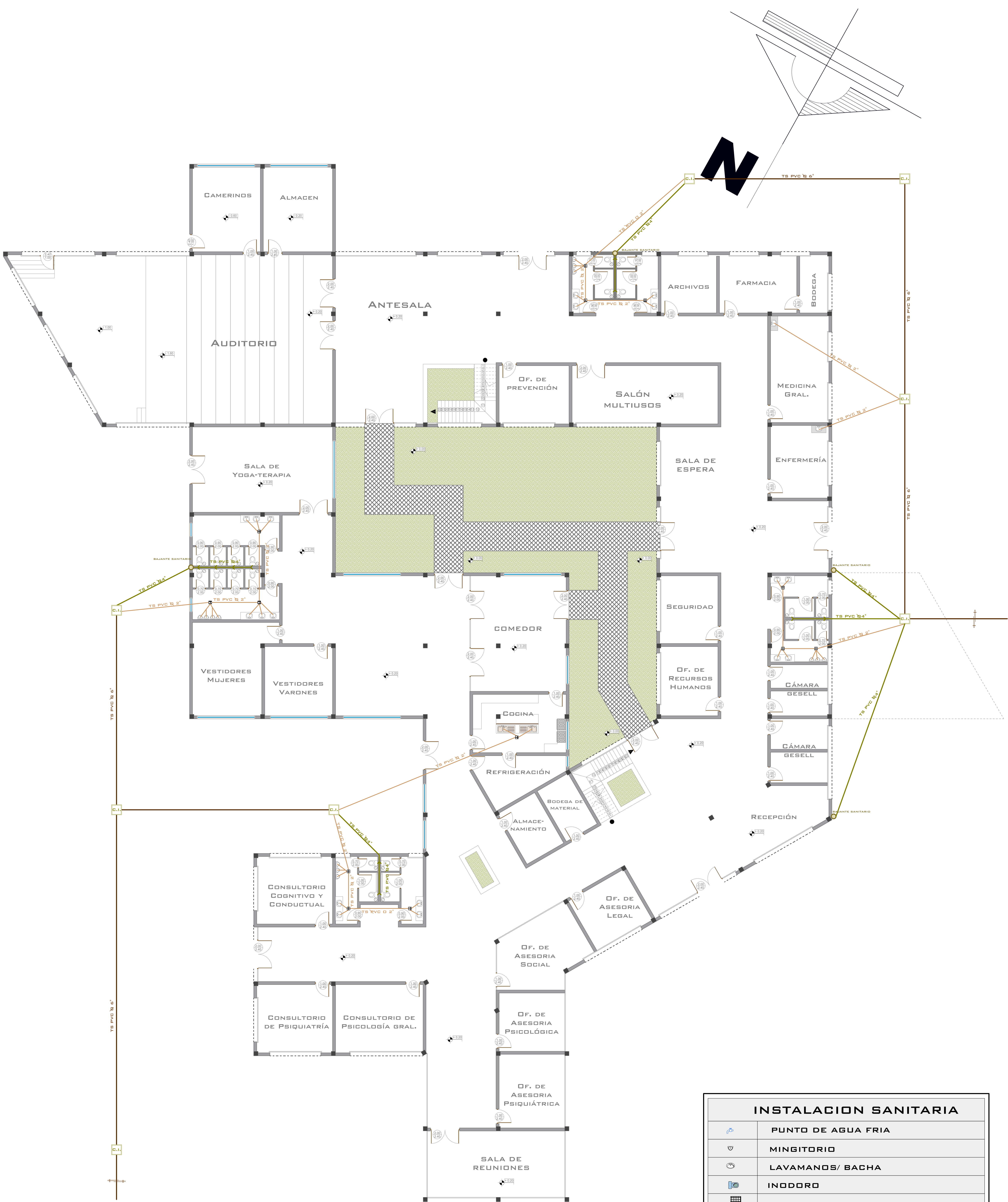
PLANTA BAJA INSTALACIÓN SANITARIA ESCALA 1: 100
