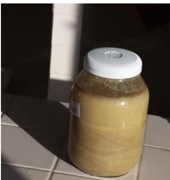
Figura 7.36 prueba de sedimentación de la arcilla amarilla
