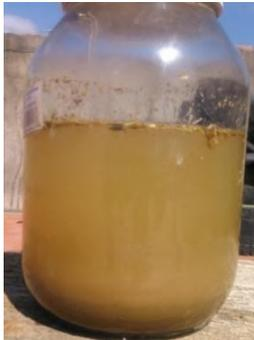
Figura 7.44. Prueba de sedimentación
