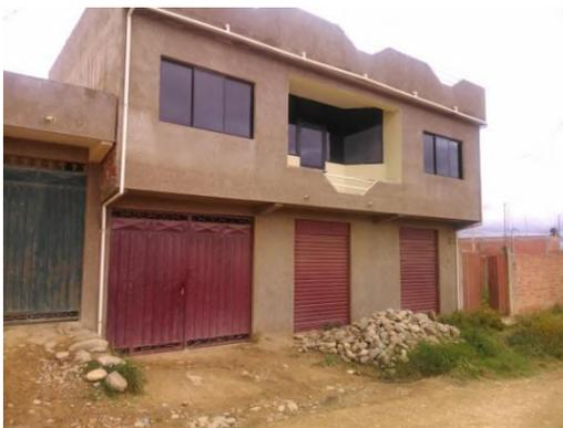
Figura 2.4.21 Vivienda comercio en la fachada de dos plantas, aislada, materiales utilizados: hormigón, ladrillo y cubierta de losa.
