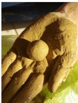
La tierra molida se amasa con agua hasta conformar una bola de diámetro de 5cm, una vez que es secada se toma con los tres dedos para tratar de romperla y de esa forma comprobar su resistencia del suelo arcilloso.
