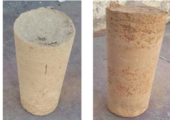
Figura 7.45 probetas de tierra apisonada
