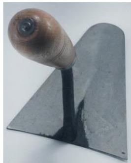
Figura 7.53 Paleta de albañilería.
