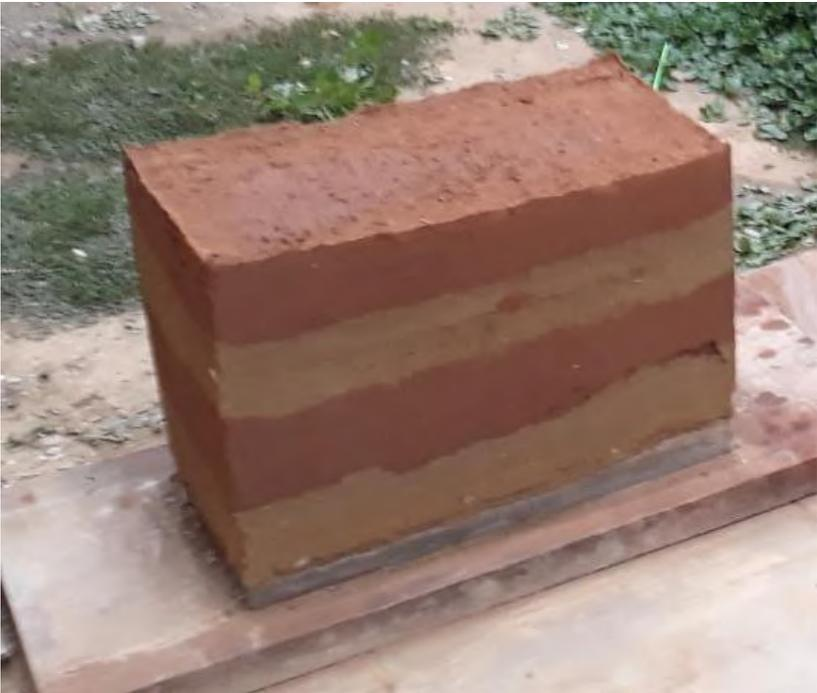
Figura 7.57 desmontaje y acabado del tapial
