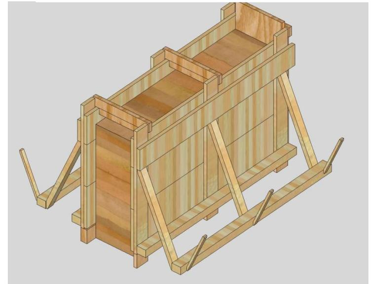
DETALLE DE ENCOFRADO
