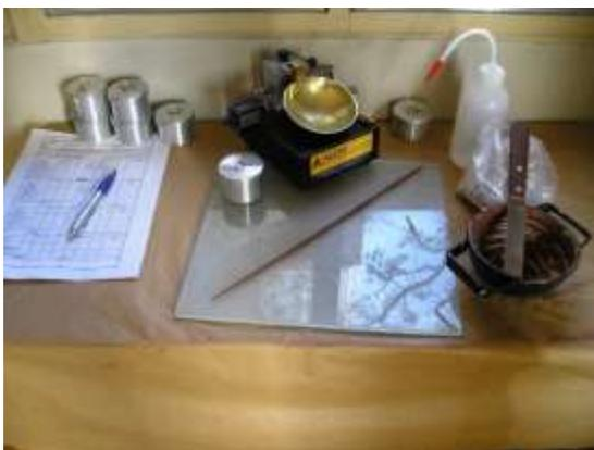
Los ensayos se realizan en el laboratorio y miden la cohesión del terreno y su contenido de humedad, para ello se forman pequeños cilindros de espesor con el suelo. Siguiendo estos procedimientos se definen tres límites:
