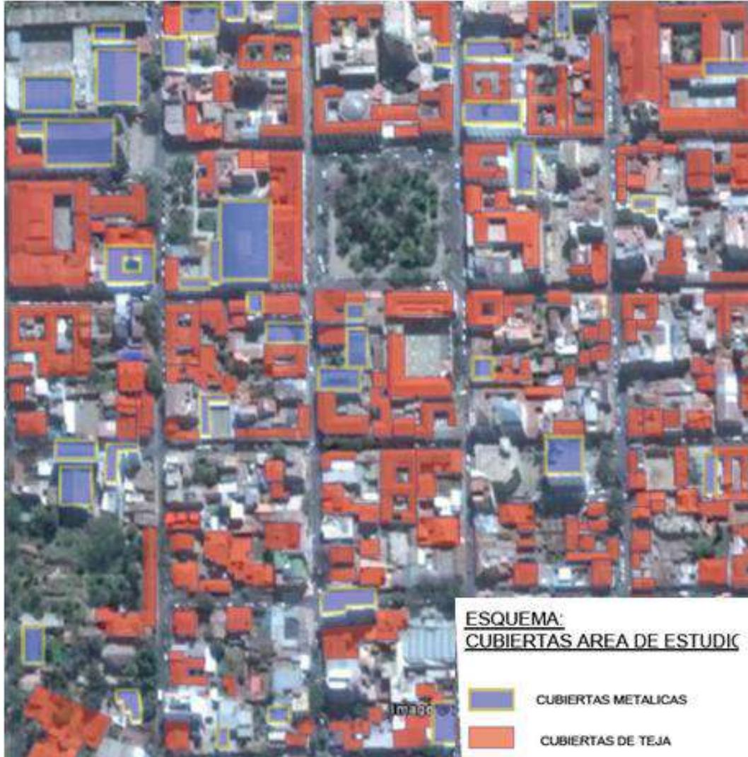
En el presente esquema se puede observar, aun la predominancia de cubiertas de teja sobre las cubiertas metálicas, sin embargo, existen elementos de grandes dimensiones de material metálico, estos elementos van en aumento, y en cambio los tradicionales están disminuyendo en mayor medida.
