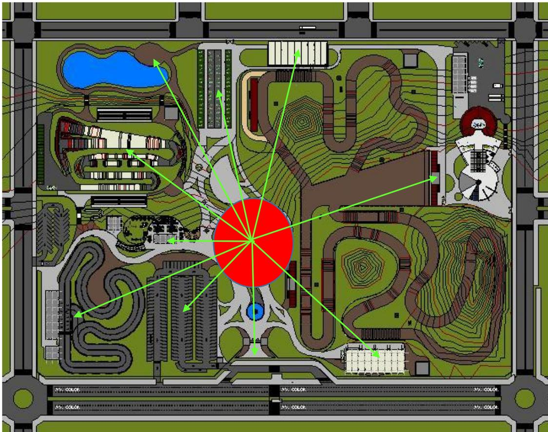
Distribución morfológica.- se logro concretar la distribución en planta del conjunto ya que su escala es amplia. La solución radial fue la mas optima ya que con este se puede ordenar todo el complejo mediante un punto central del cual todos los equipamientos se comunican.
