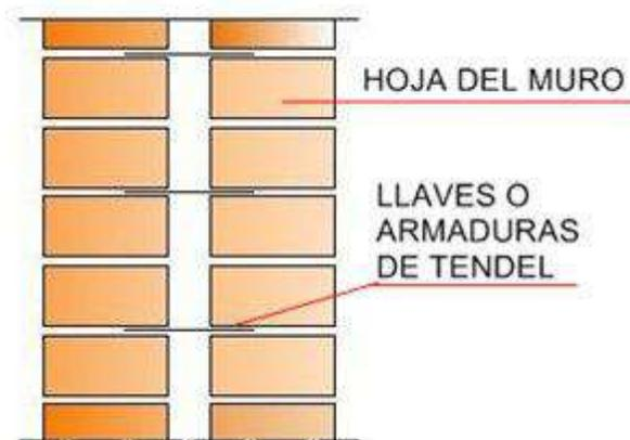
por dos muros de una hoja paralelos, eficazmente enlazados por llaves, conectores o armaduras de tendeles con una o ambas
