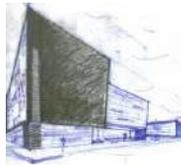
Una estructura sencilla permite la colocación de locales en la planta baja y de garaje en la planta sótano, como una calle subterránea que tiene salida hacia la rotonda del extremo norte de la calle Rascanya, futuro nodo principal de la zona. A esta rotonda recae la curva más monumental y aguda de la propuesta, jugando con el desnivel y permitiendo el acceso por debajo del edificio hacia el espacio común interior, a modo de una lengua que se levanta y acoge a los que vienen por el norte.
