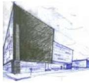
La función está delimitada por cuatro departamentos que están ubicadas prácticamente en las cuatro esquinas del paralelepípedo y que son conectadas por una circulación lineal horizontal y otra vertical que comunica a los diferentes pisos de departamentos con Planta Baja que viene a ser locales comerciales y el Sótano que es una área de parqueo y deposito.
