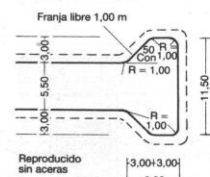
⑤ Plazoleta en forma de «T» de cambio de sentido para turismos y camiones hasta 8 m de longitud (camiones de basuras, coches de bomberos y camiones de 6 t)
