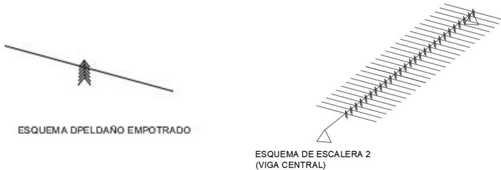
Para la idealización de la viga central de apoyo de los peldaños será una viga simplemente apoyada en sus extremos.
