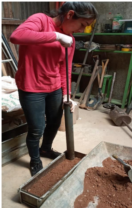
Figura 49 Compactación de la viga
