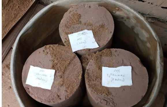
Figura 45 Curado de las probetas
