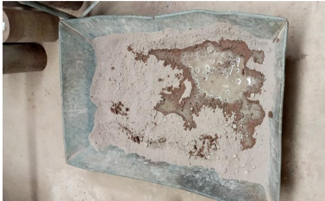
Figura 48 Adición del agua al suelo - cemento
