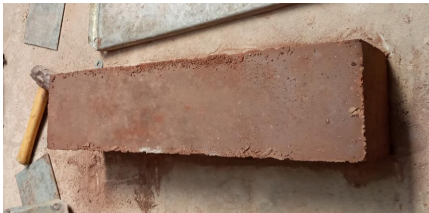
Figura 50 Viga de suelo - cemento
