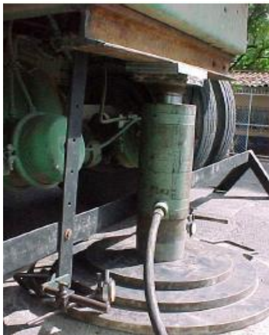
Figura 10 Placa de carga (AASHTO T-222)
