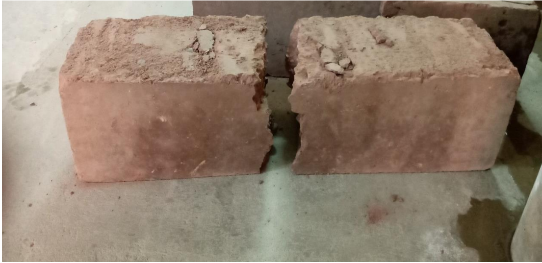
Figura 55 Rotura de viga
