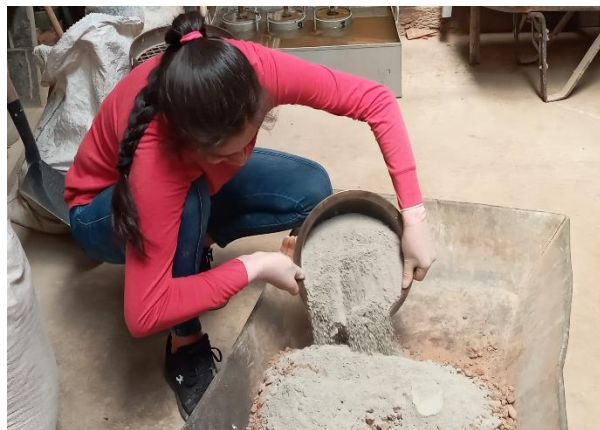
Figura 39 Mezcla total del espécimen, suelo y cemento
