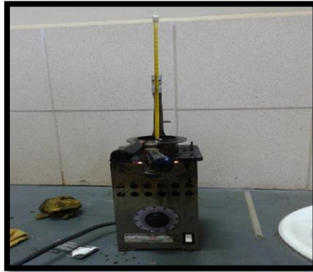
Figura C.12. Proceso de calentamiento del material bituminoso y control de la temperatura
