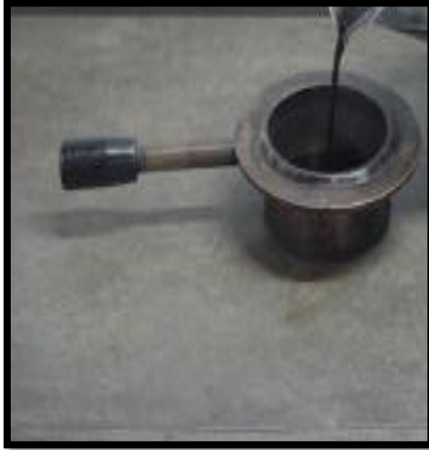
Figura C.11. Vertido de la muestra en el vaso
