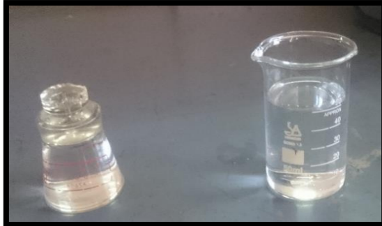
Figura C.20. Vertido de agua destilada en los picnómetros
