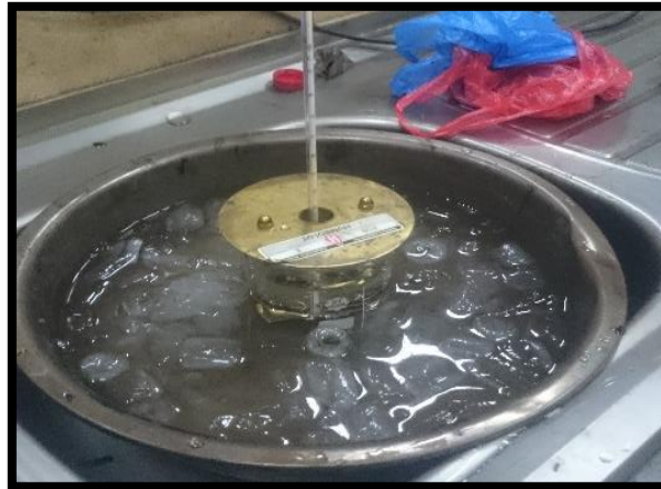
Figura C.17. Proceso para bajar la temperatura a 4°C
