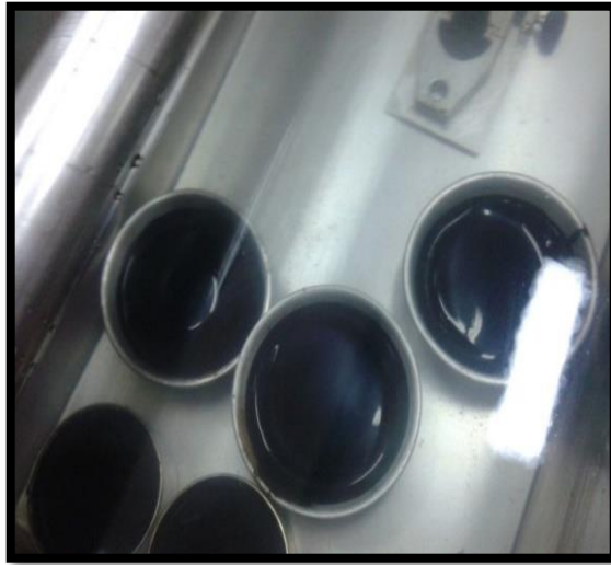
Figura C.3. Muestra sumergidas en baño de agua a 25°C
