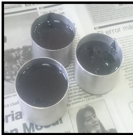
Figura C.2. Vertido del cemento asfáltico en las cápsulas
