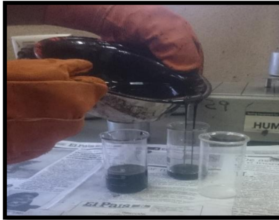
Figura C.21. Vertido de cemento asfáltico
