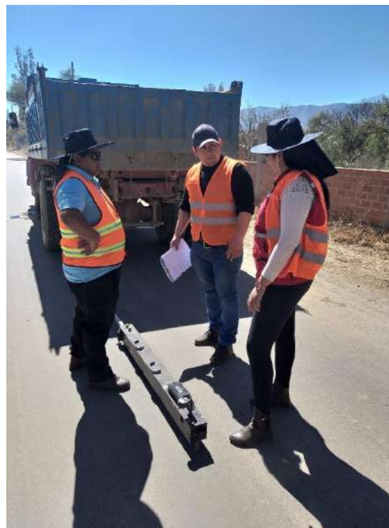
Procedimiento de ensayo de la viga Benkelman
