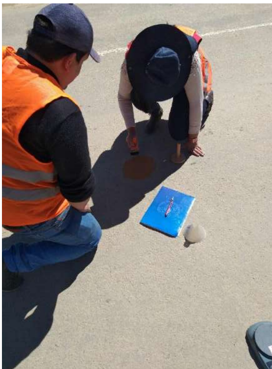
Ejecución del ensayo de circulo de arena
