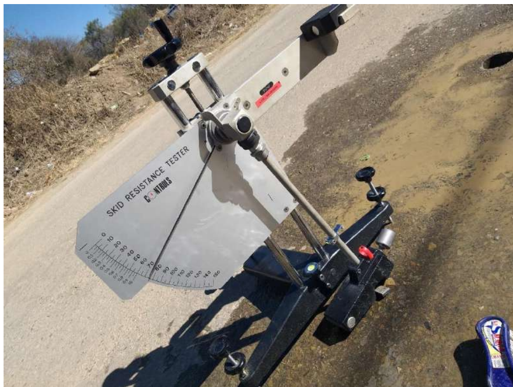
Calibración del Péndulo Inglés
