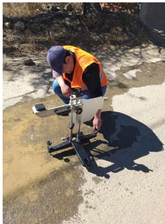
Ejecución del ensayo condición del pavimento mojado
