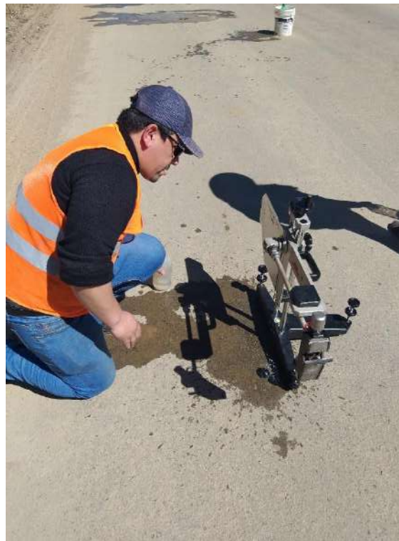
Ejecución y lectura del ensayo del Péndulo Inglés
