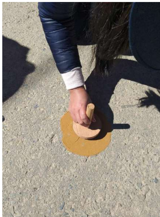
Ejecución del ensayo de circulo de arena
