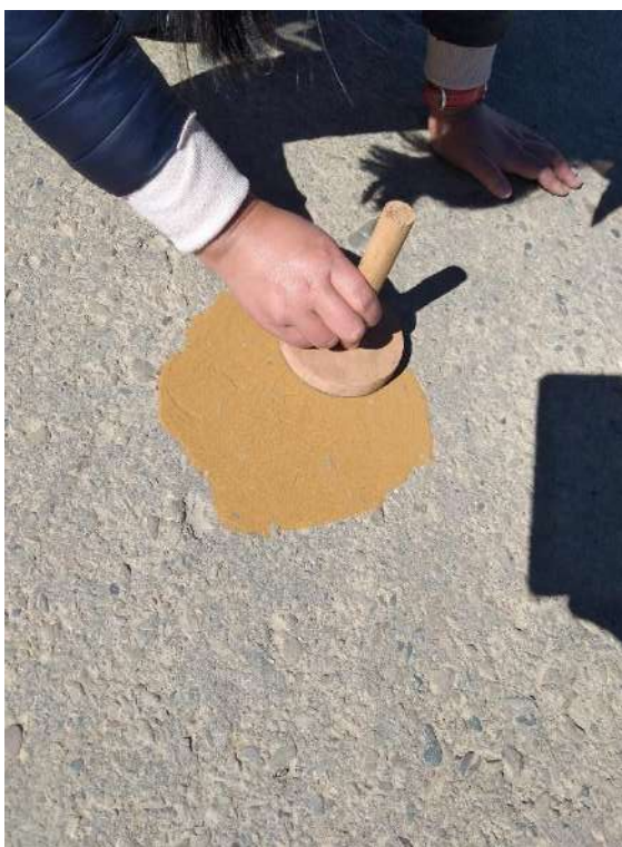
Ejecución del ensayo de circulo de arena
