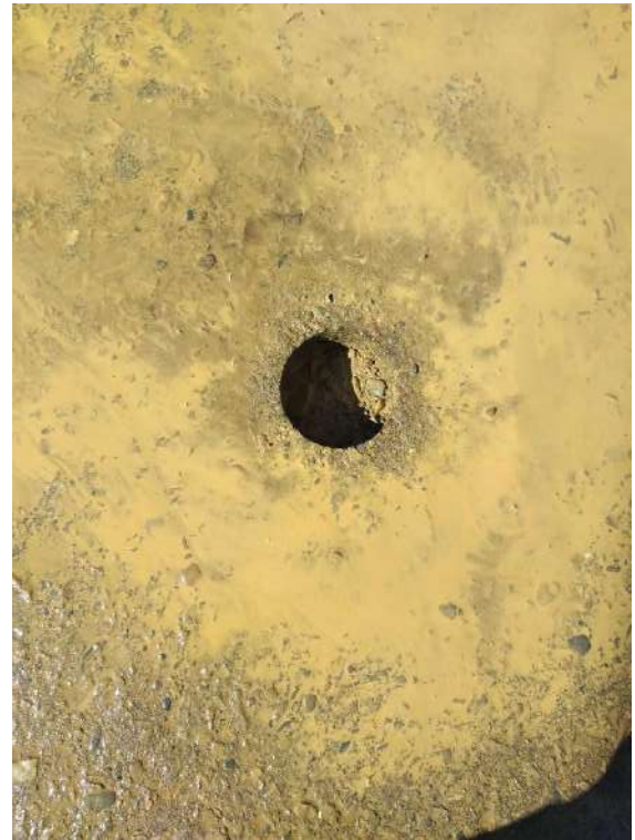
Ensayo de extracción de núcleo
