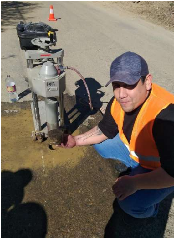
Ensayo de extracción de núcleo
