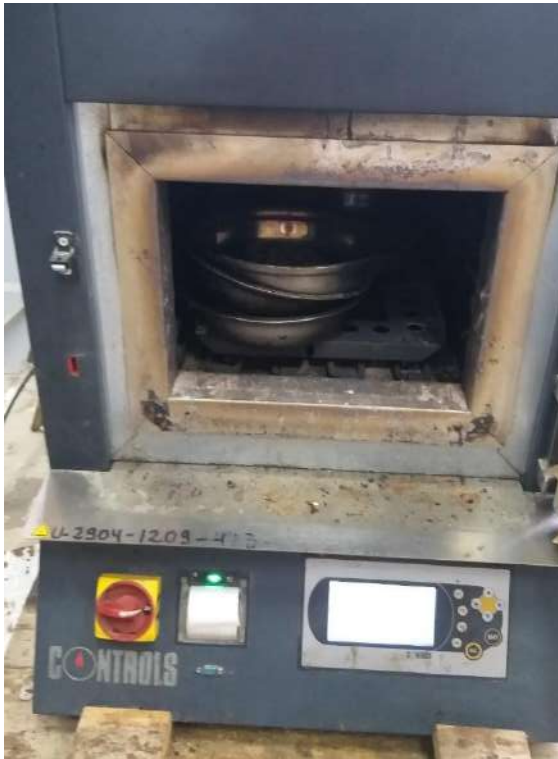
Ensayo en laboratorio para determinar contenido de cemento asfaltico
