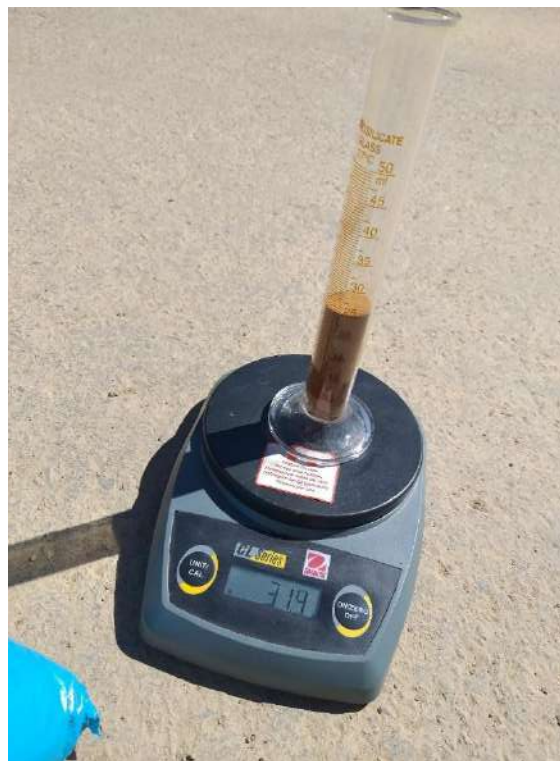
Pesaje de 25 cm 3 de arena para realizar ensayo de círculo de arena
