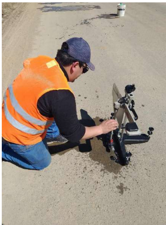
Ejecución del ensayo condición del pavimento mojado
