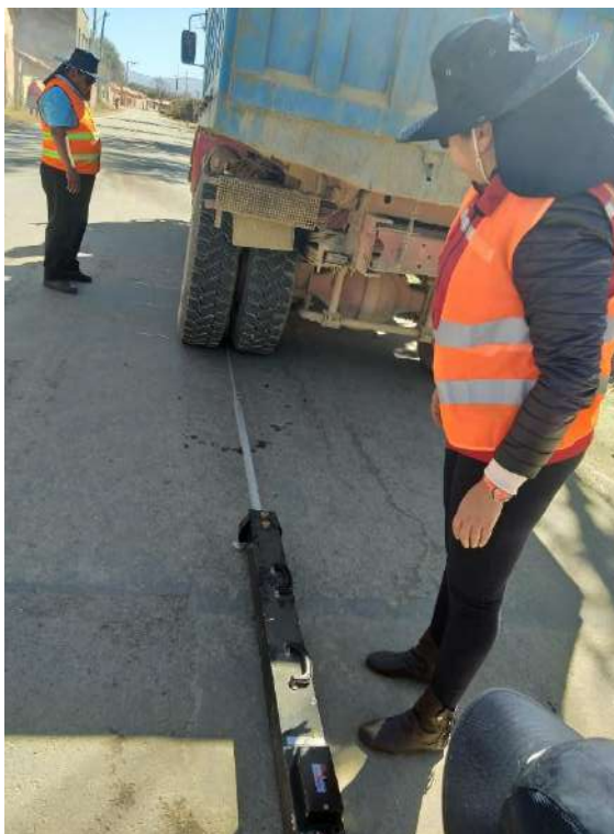
Procedimiento de ensayo de la viga Benkelman
