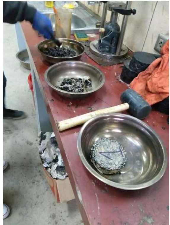
Ensayo en laboratorio para determinar contenido de cemento asfaltico
