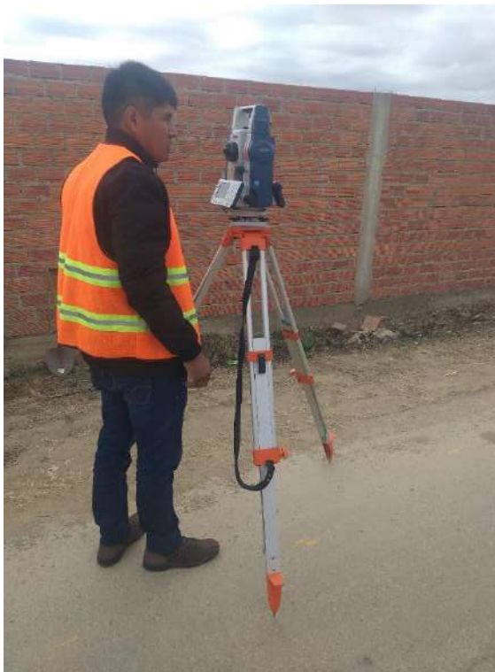
Procedimiento del ensayo del IRI con estación total con apoyo técnico en topografía
