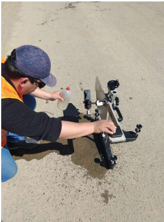
Ejecución y lectura del ensayo del Péndulo Inglés
