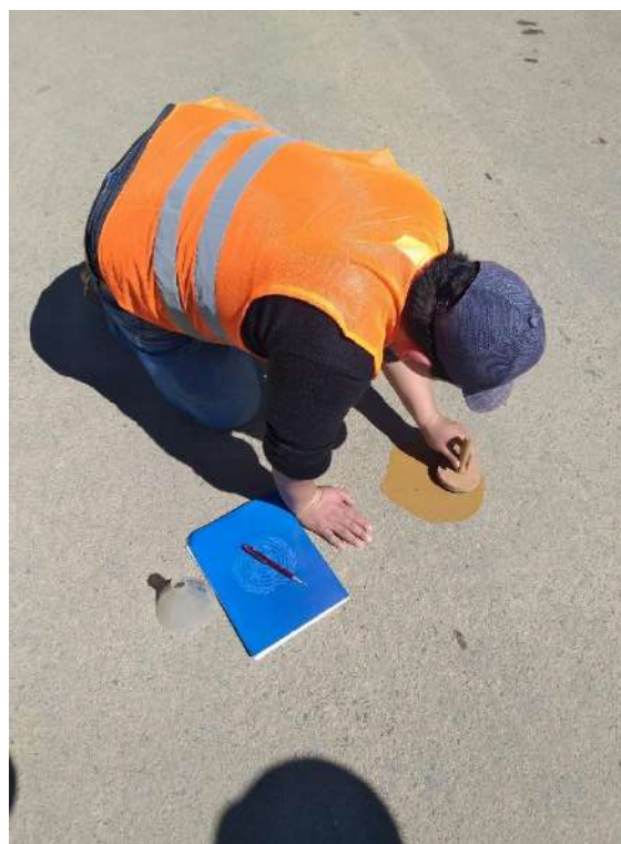
Ejecución del ensayo de circulo de arena
