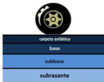
Gráfico 2.1:1 Estructura del pavimentó flexible
