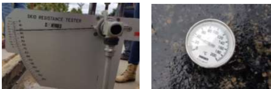
Imagen 3.2:3 Lecturación del péndulo y la temperatura del pavimento
