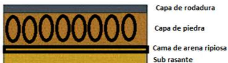
Gráfico 2.4:1 Estructura de un pavimento flexible sobre empedrado
