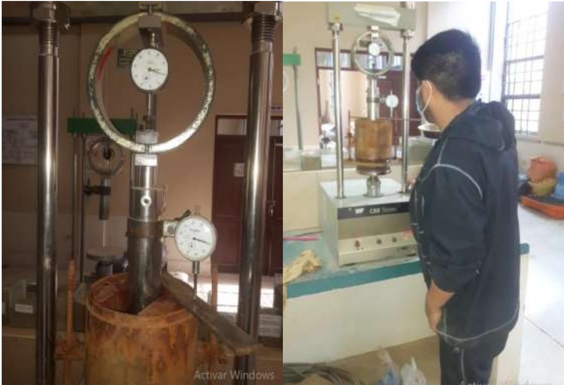
Medición del ensayo de penetración.
