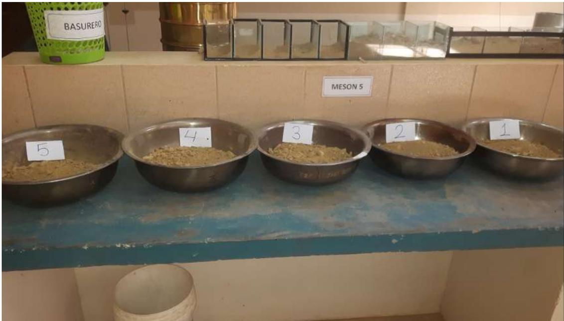
Muestras preparadas para realizar el ensayo de compactación.
