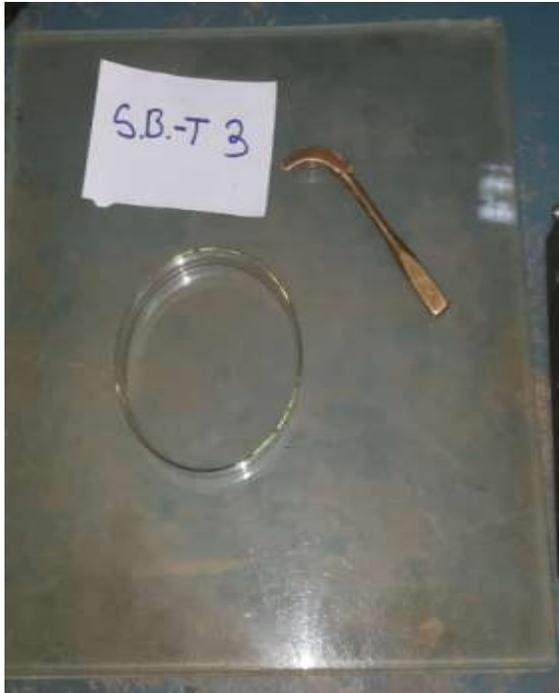
Equipo para realizar el ensayo de limite plastico.
