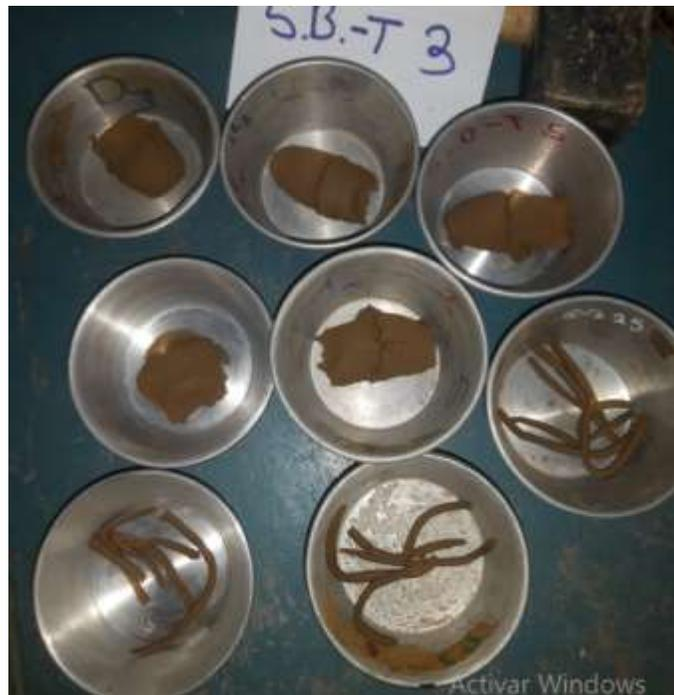
Material de limite liquido como el limite plastico listo para hacer secar en horno
