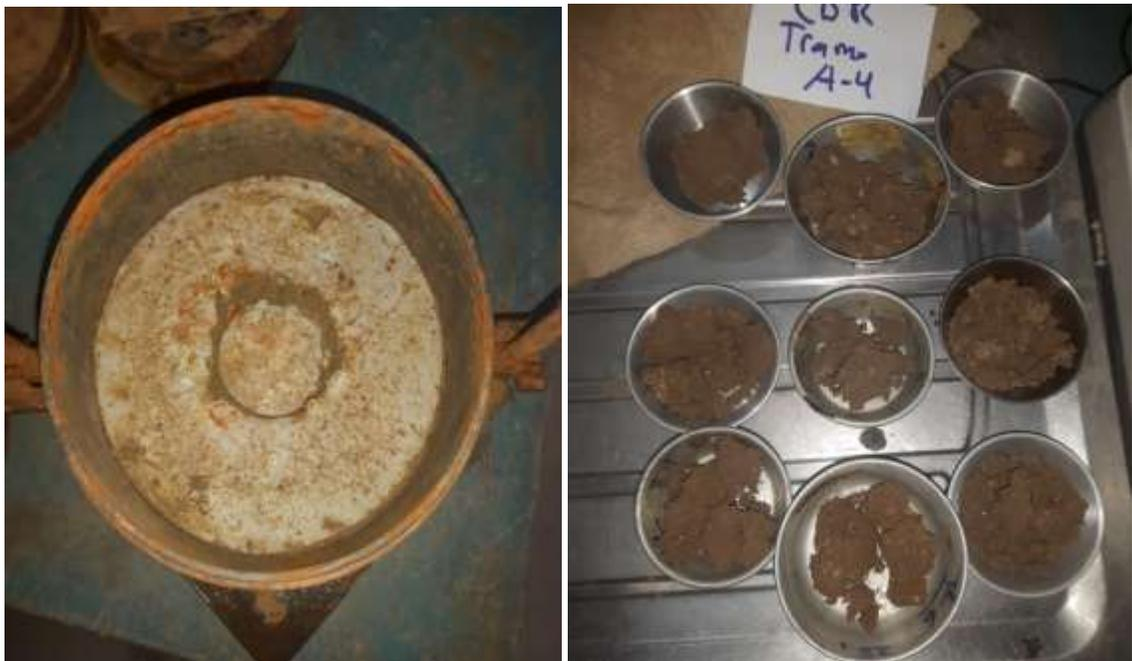
Muestra luego del ensayo de penetración.
