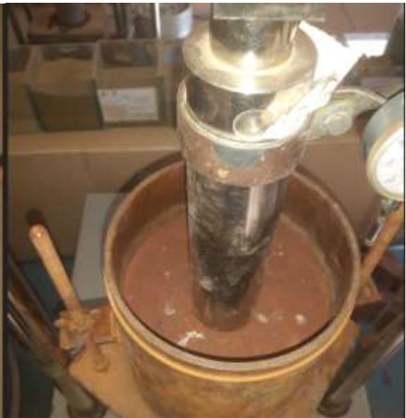
Ensayo de penetración.
