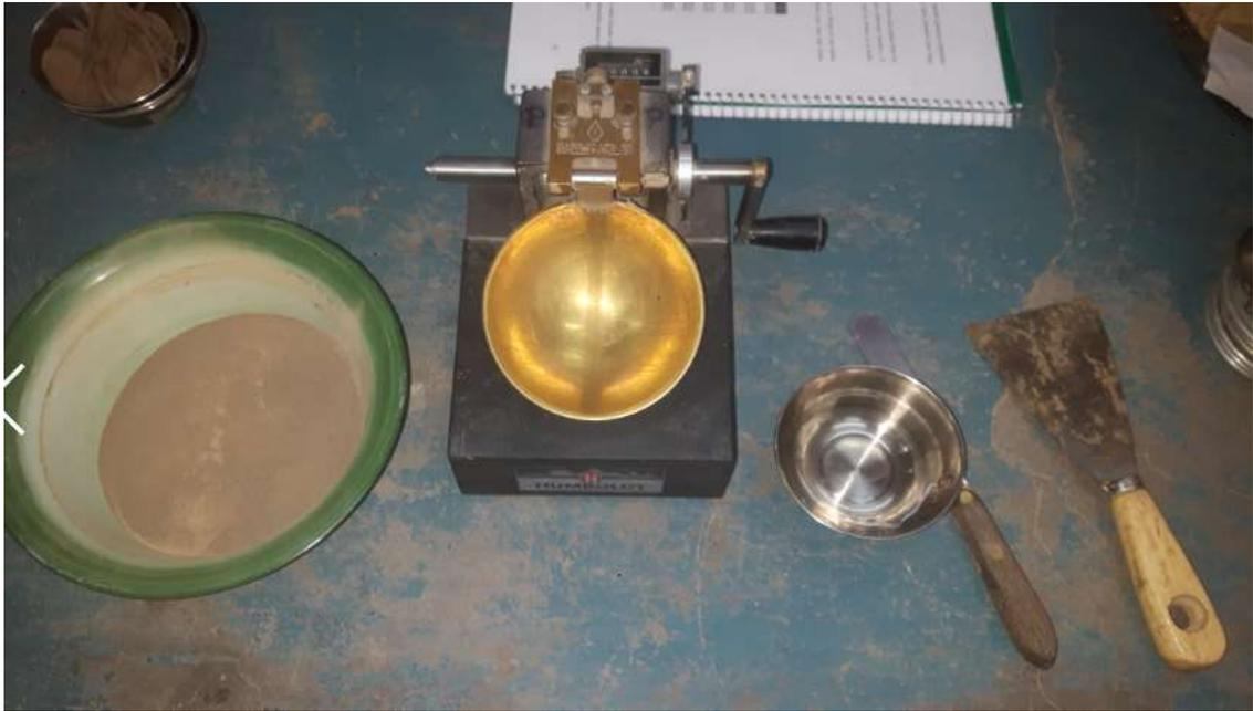
Material usado para realiar el ensayo limite liquido.
