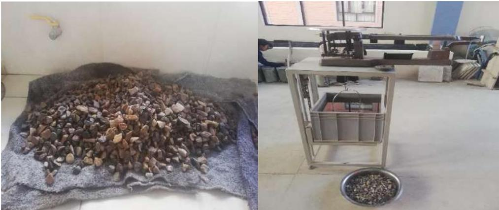
Realización del ensayo de peso específico en el agregado fino:
