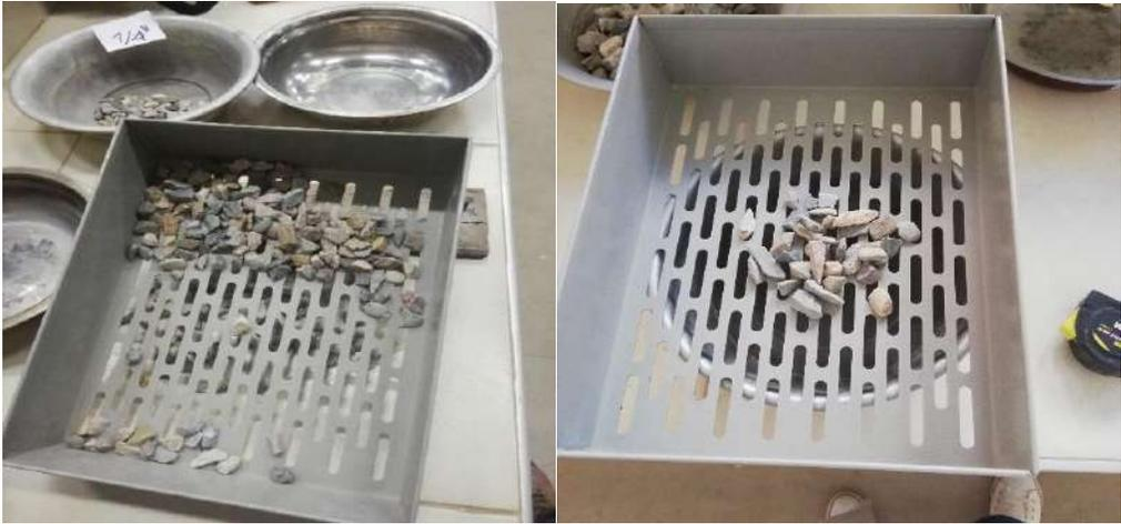
Realización del ensayo índice de alargamiento de los agregados gruesos:
