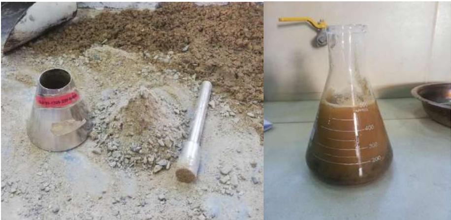
Realización del ensayo de equivalente de arena:
