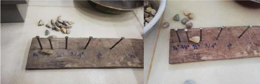
Realización del ensayo de peso específico en el agregado grueso:
