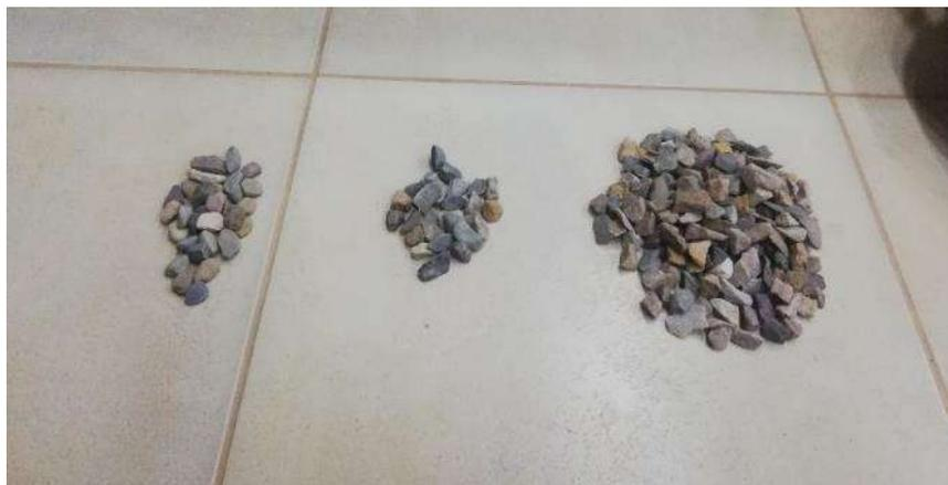
Realización del ensayo de desgaste máquina de los Ángeles:
