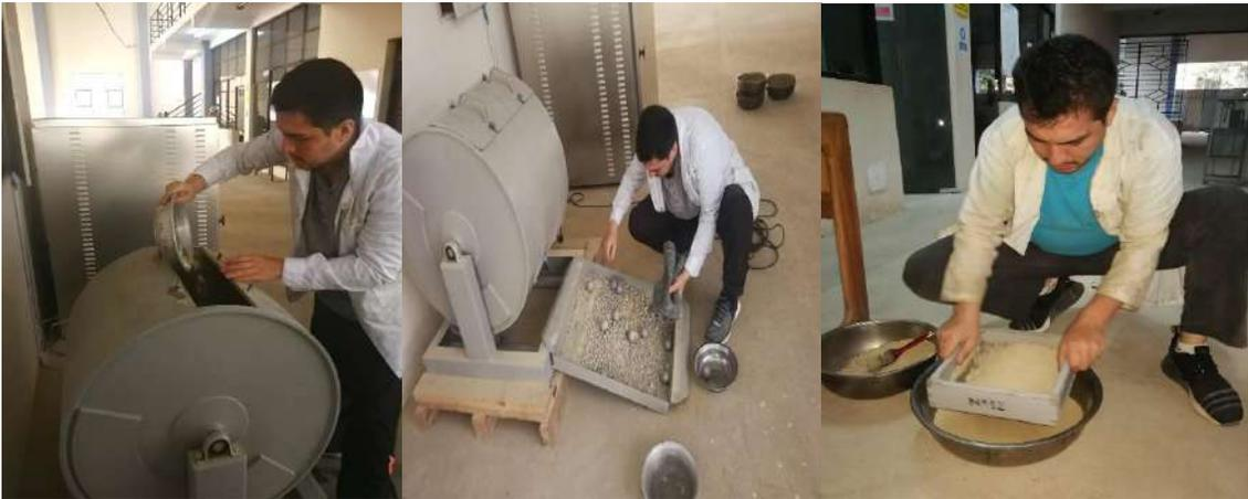
Realización del ensayo de índice de aplanamiento de los agregados gruesos:
