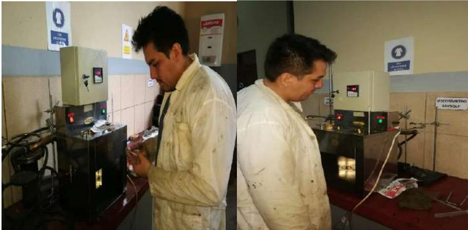
Realización de las briquetas con el método Superpave y Marshall:
