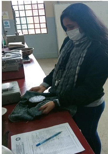
Figura C.10 Determinación del peso saturado con superficie seca
