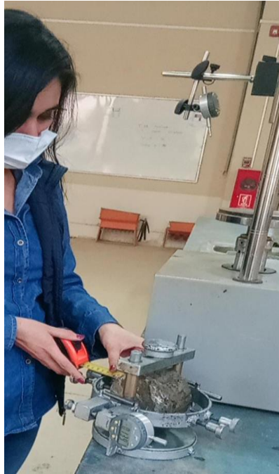
Figura C.31 Colocado de la briketa en la prensa y dispositivo de sujeción
