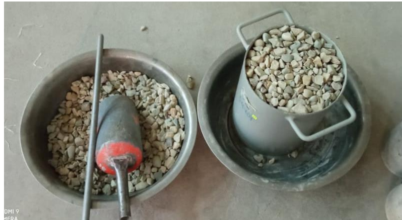
Figura A.18. Peso unitario compactado del agregado grueso
