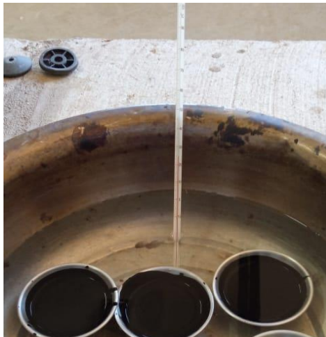
Figura B.3. Muestra sumergidas en baño de agua a 25°C
