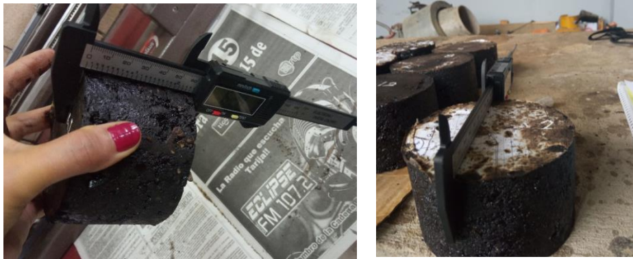
Figura C.7 Determinación de las dimensiones de las briquetas
