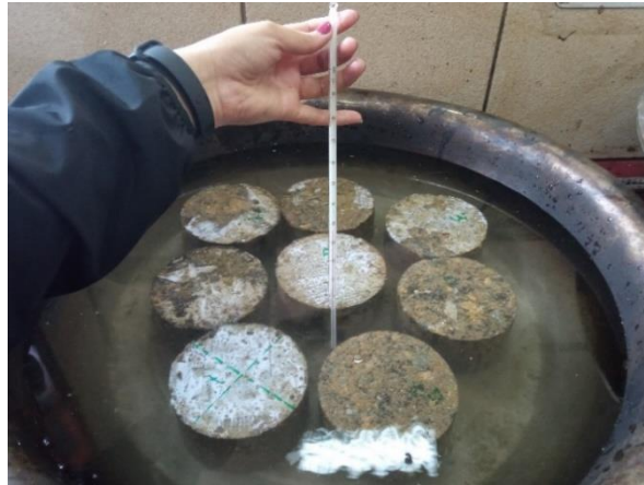
Figura C.21 Briquetas en baño María a 25\text{ }^{\circ}\text{C}
