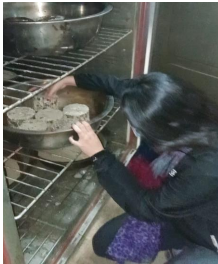
Figura C.18 Colocado de las briquetas en horno para su curado
