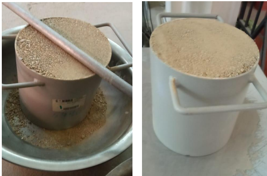
Figura A.16 Peso unitario suelto del agregado grueso y fino
