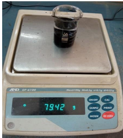
Figura B.22 Peso del picnómetro + agua + C.A
