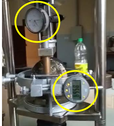
Figura C.26 Diales para la medición de la deformación vertical y horizontal
