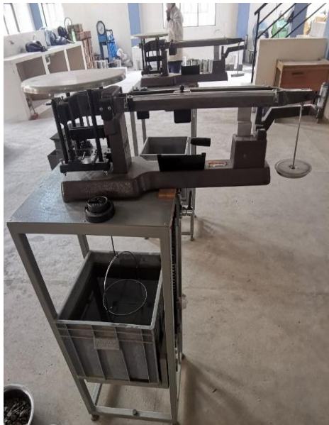
Figura A.10. Determinación del peso sumergido
