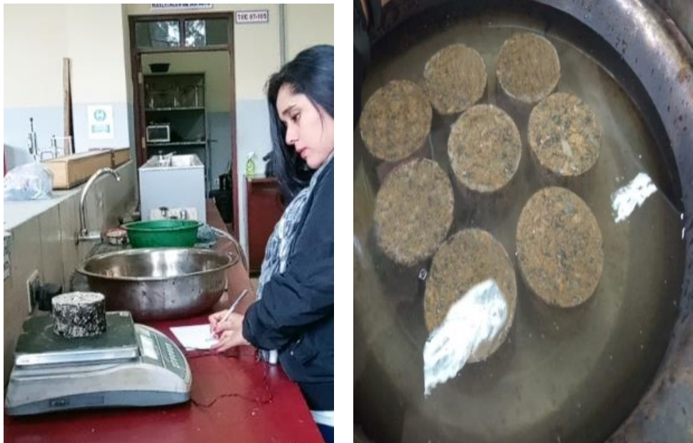
Figura C.20 Determinación del peso es estado seco y sumergido
