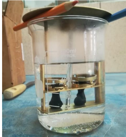
Figura B.19 Conclusión del ensayo de punto de ablandamiento cuando las esferas traspasaron y llegaron a la parte inferior del vaso
