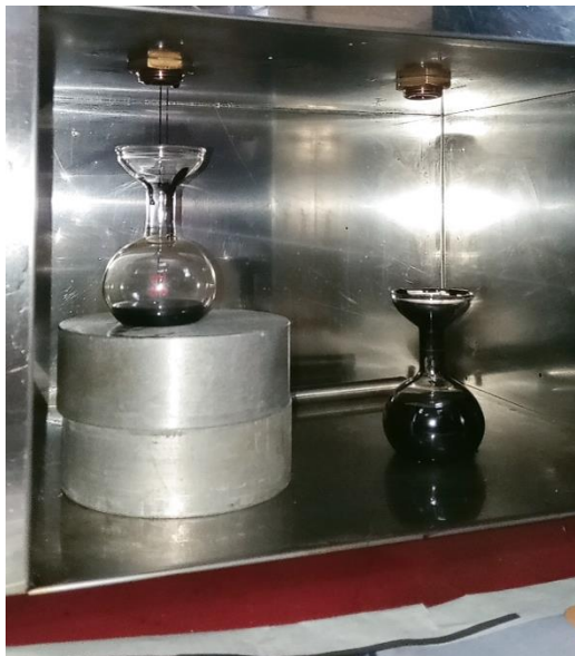
Figura B.13. Realización del ensayo de viscosidad saybolt furol
