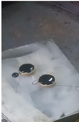
Figura B.16 Colocado del cemento asfáltico en los anillos
