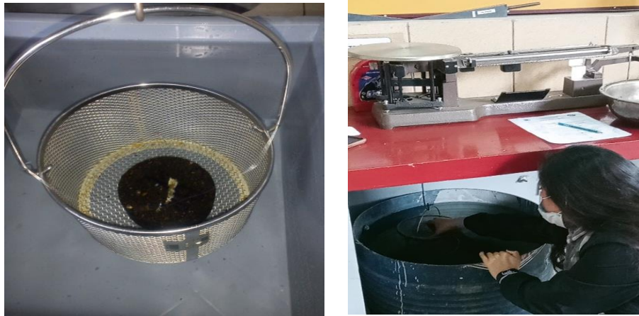
Figura C.11 Determinación del peso sumergido
