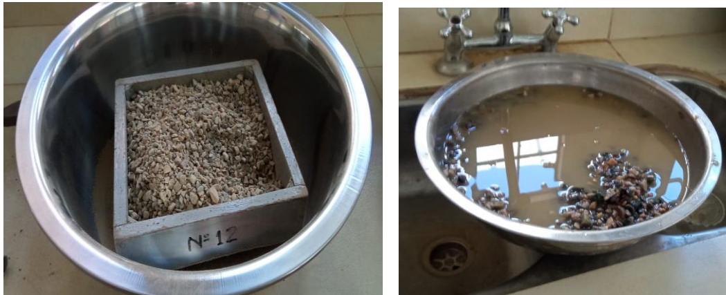
Figura A.7 Tamizado del material en el tamiz N° 12 y lavado
