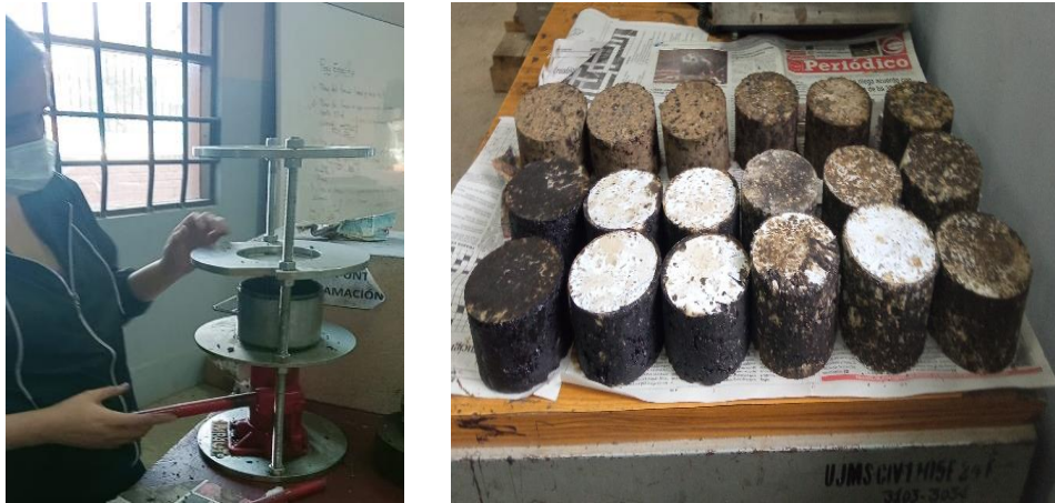
Figura C.17 Extracción de las briquetas transcurrido el tiempo de 24 hr. dentro del molde
