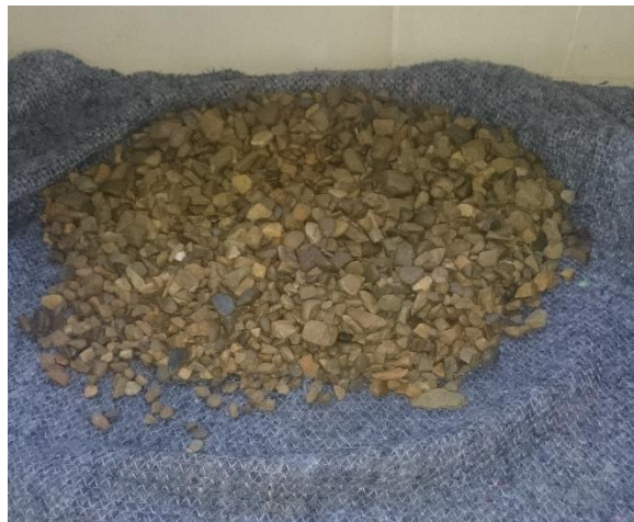
Figura A.9. Muestra con partículas saturadas superficialmente secas
