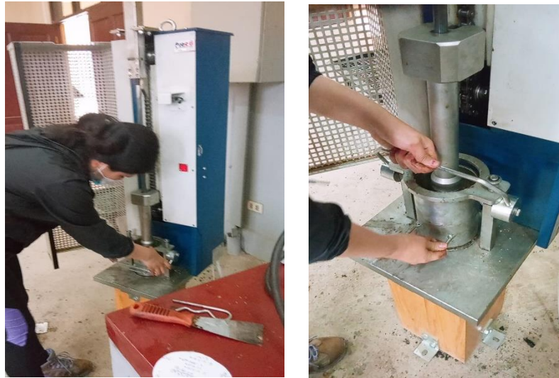
Figura C.5 Compactado de la mezcla
