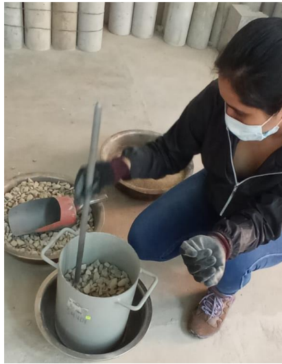
Figura A.17. Apisonado del agregado con 25 golpes
