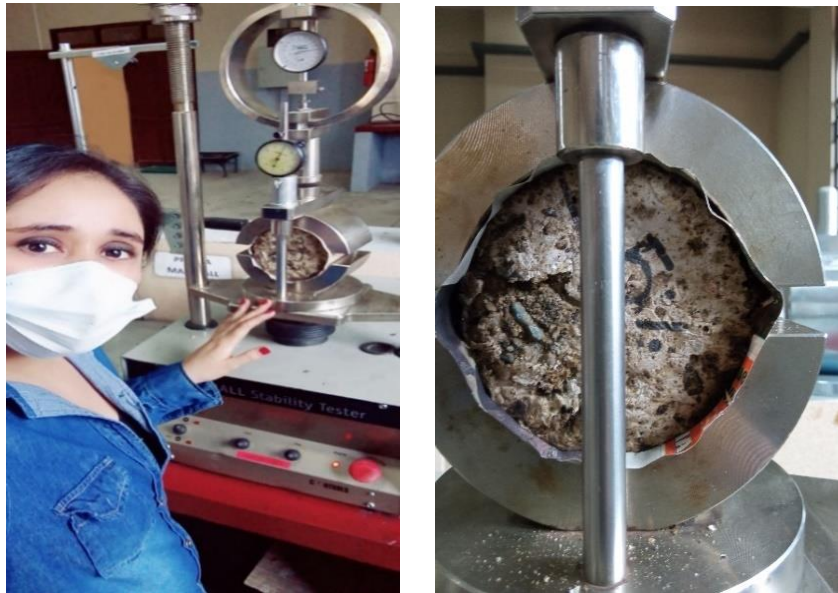
Figura C.22 Determinación de la estabilidad y fluencia
