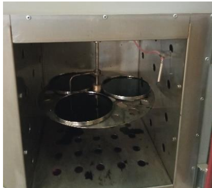
Figura B.24 Colocado en horno los platillos + cemento asfáltico
