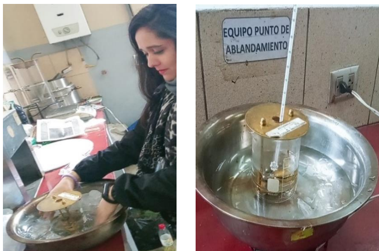
Figura B.17 Proceso para bajar la temperatura a 4°C
