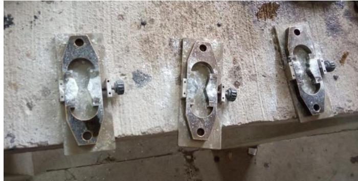
Figura B.6 Preparado de moldes con antiadherente (vaselina y talco)
