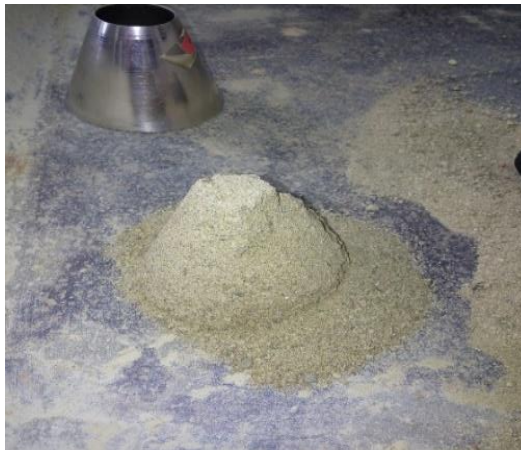
Figura A.14. Condición de saturado con superficie seca
