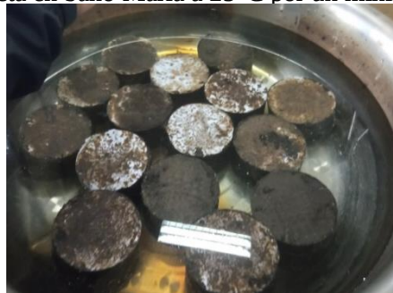
Figura C.9 Briqueta en baño María a 25^{\circ}\text{C} por un mínimo de 10 minutos
