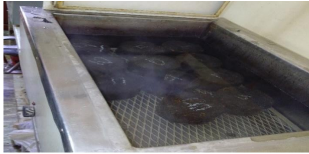
Figura C.12 Briquetas sumergidas en baño María a 60°C
