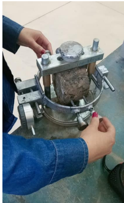
Figura C.31 Colocado de la briketa en la prensa y dispositivo de sujeción
