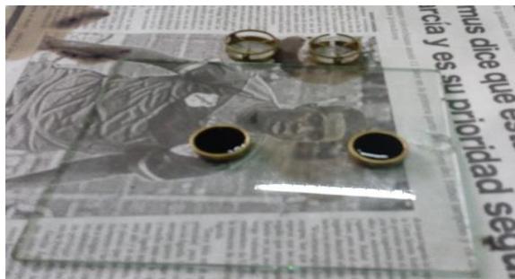
Figura B.34 Colocado del asfalto residual en los anillos sobre una plancha amalgada
