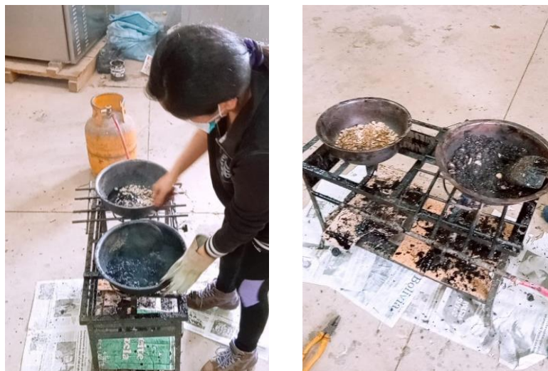
Figura C.27 Elaboración de las briquetas Marshall
