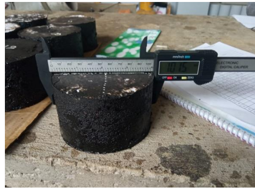
Figura C.29 Determinación del peso y dimensiones de las briquetas
