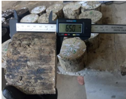
Figura C.29 Determinación del peso y dimensiones de las briquetas
