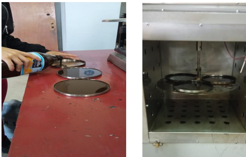
Figura B.32 Vertido de la emulsión en los platillos y colocado en el horno giratorio
