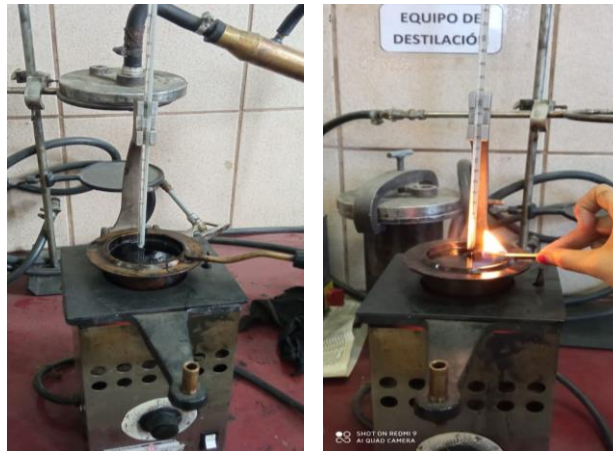
Figura B.11 Proceso de calentamiento y verificación del punto de inflamación
