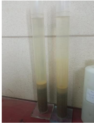
Figura A.3. Llenado de la solución hasta los 38cm
