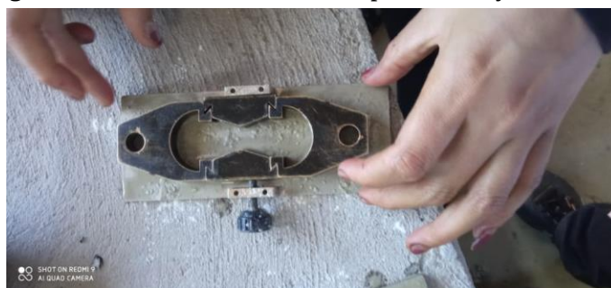
Figura B.36 Armado de los moldes para el ensayo de ductilidad
