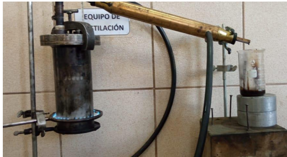
Figura B.29 Residuo destilado finalizado el ensayo
