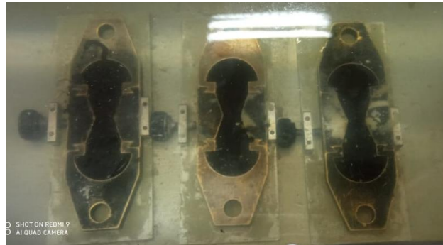
Figura B.8 Muestras sumergidas en baño María a 25°C
