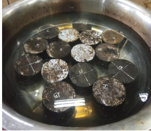
Figura C.30 Acondicionamiento térmico de las briquetas
