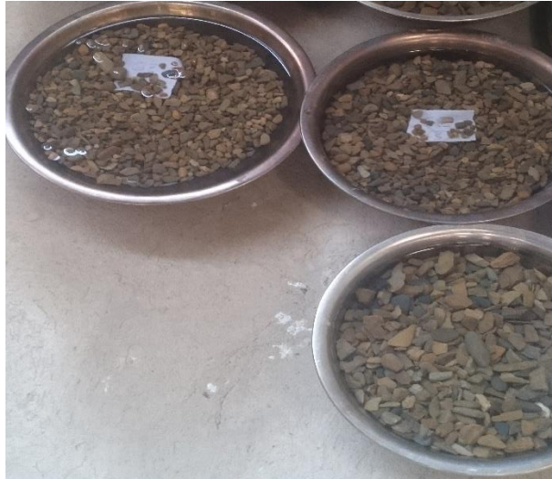
Figura A.8 Material sumergido en agua por 24 horas
