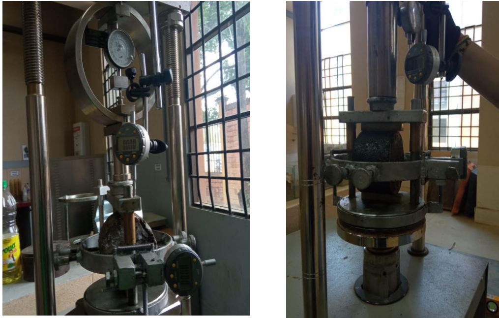
Figura C.32 Aplicación de carga
