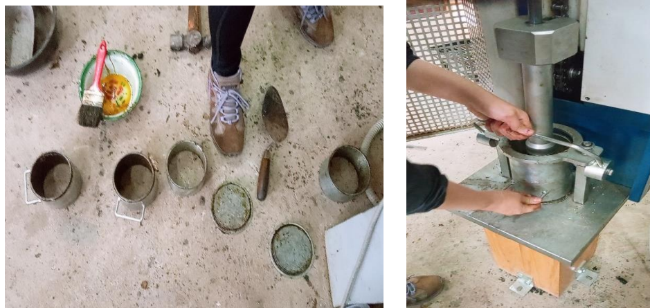
Figura C.16 Moldes con la mezcla y su posterior compactado
