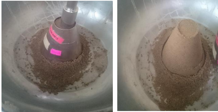
Figura A.13. Verificación de la condición de saturado con superficie seca
