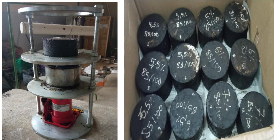
Figura C.6 Extracción de las briquetas
