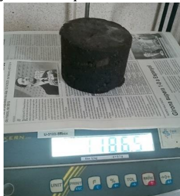
Figura C.8 Pesaje de las briquetas en su estado seco al aire libre
