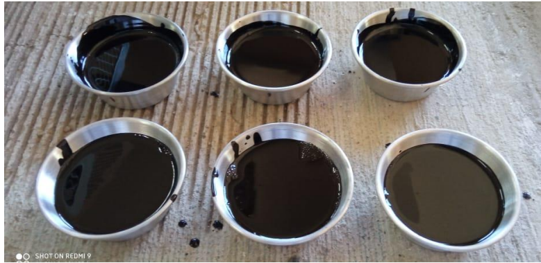
Figura B.2. Vertido del cemento asfáltico en las cápsulas
