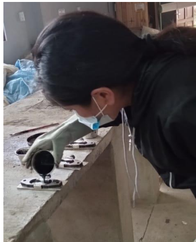
Figura B.7. Vertido del asfalto en los moldes
