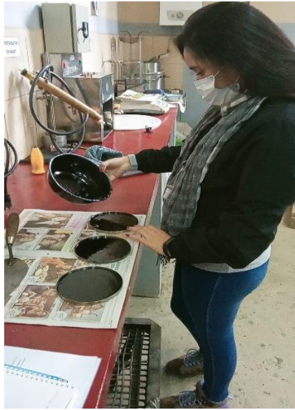
Figura B.23 Vertido de cemento asfáltico en los platillos
