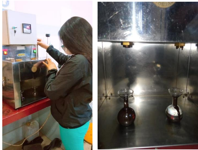
Figura B.26 Ensayo de viscosidad
