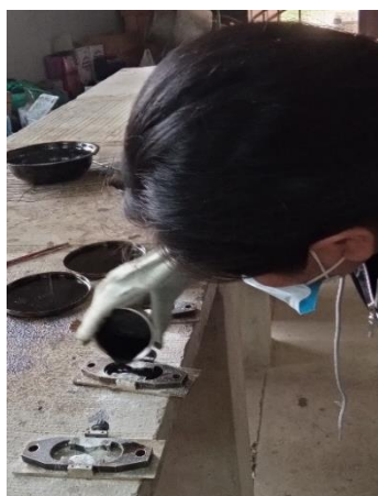
Figura B.37 Vertido del asfalto a los moldes
