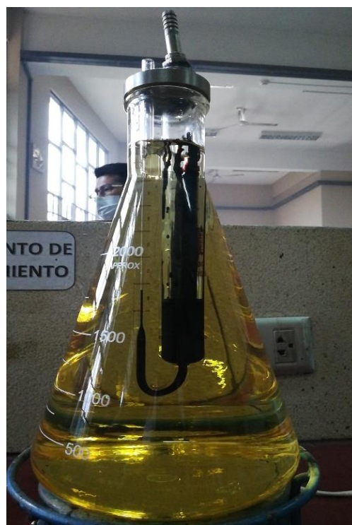
Figura 3.8: Ensayo de Viscosidad
