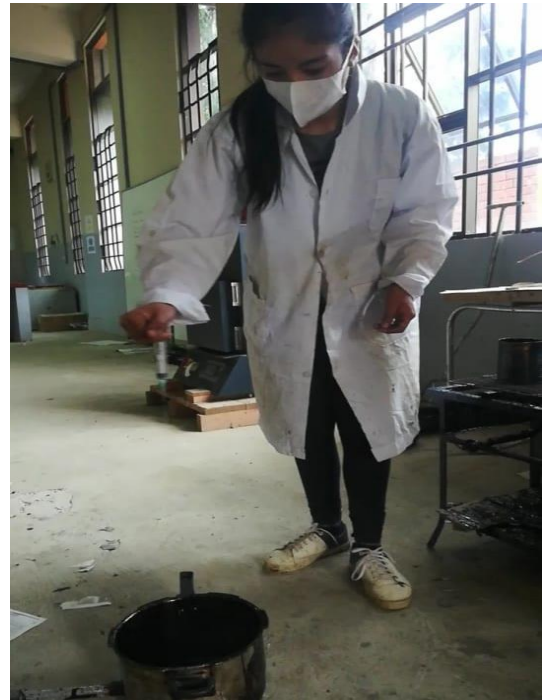
Figura 5.2: Inyección del agua para espumar.
