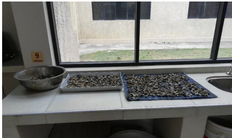
Figura 2.6: Secado superficial de gravilla p.e.
