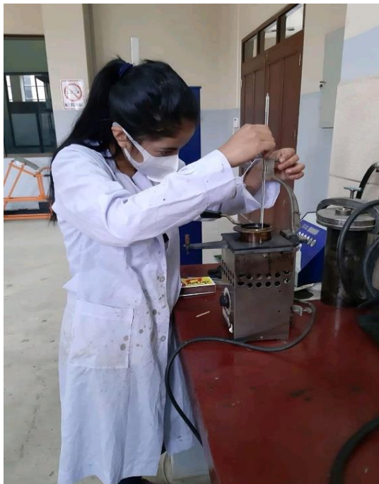
Figura3.3: Ensayo de Punto de Inflamación
