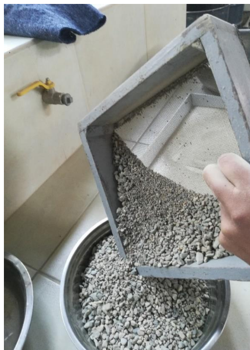
Figura 2.10: Tamizado de gravilla luego del Desgaste.
