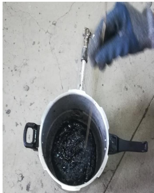
Figura 5.4: Lectura de altura de espumado
