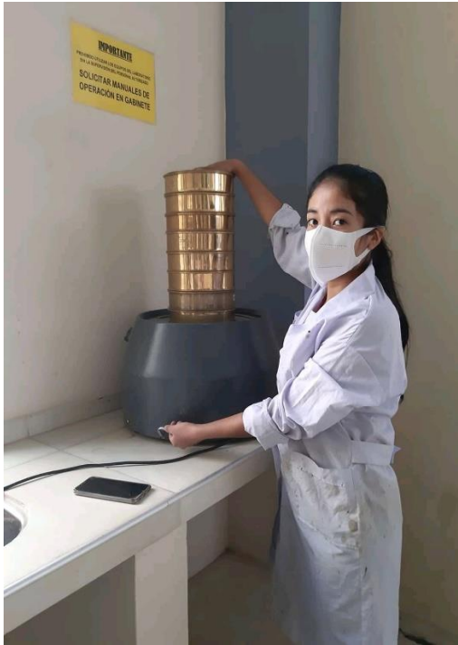
Figura 2.1: Granulometría de arena.
