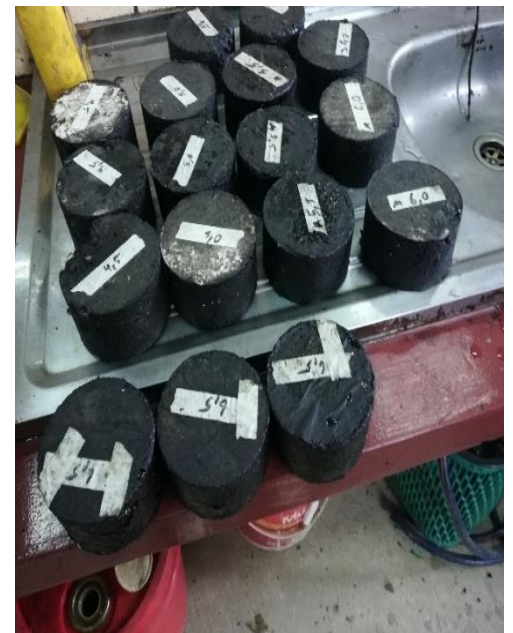
Figura 6.4: Secado de briquetas para pesaje
