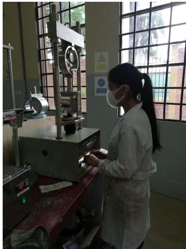
Figura 6.7: Rotura de Briquetas.
