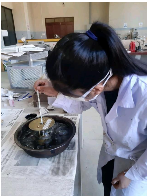
Figura 3.7: Ensayo de P. de Ablandamiento
