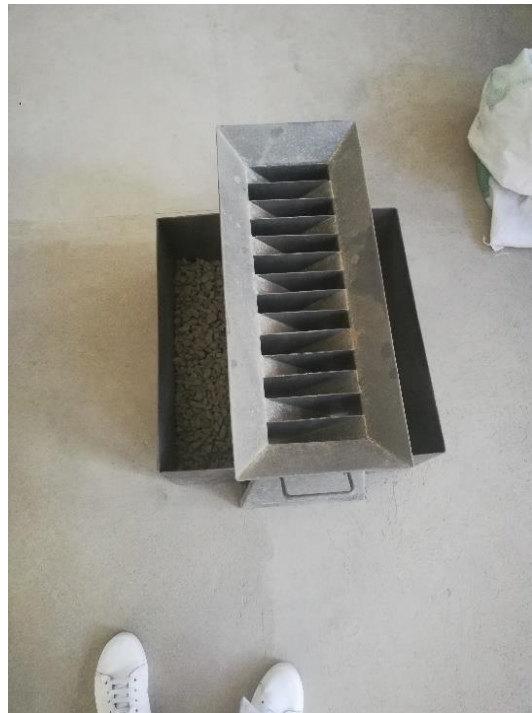
Figura 2.2: Cuarteado de agregado grueso
