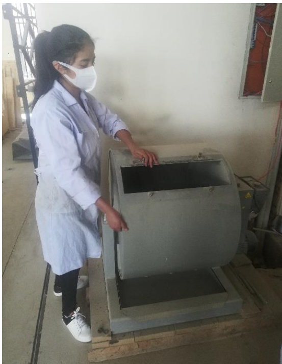
Figura 2.9: Vertimiento de esferas en la Máquina de los Ángeles.
