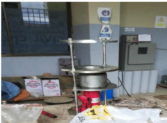
Figura 4.3: Desencofrado de briqueta.
