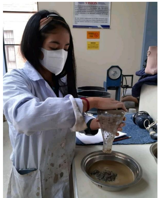
Figura 2.4: Peso específico arena, extracción para llevado al horno.
