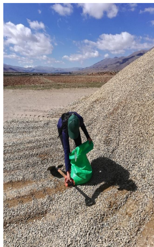
Figura 1.5: Toma de muestra de grava y gravilla.
