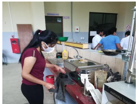
Figura 4.4: Secado de briqueta.
