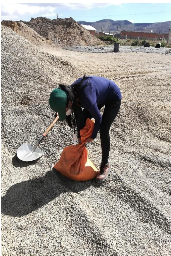
Figura 1.5: Toma de muestra de grava y gravilla.
