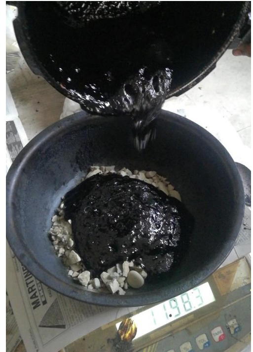
Figura 6.2: Pesaje de mezcla con asfalto espumado.
