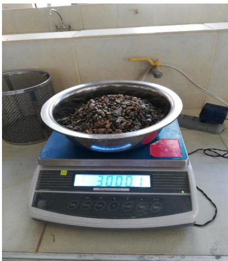
Figura 2.7: Peso de muestra de gravilla.
