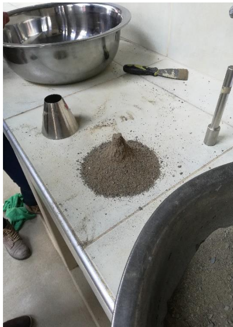
Figura 2.3: Peso específico de arena.
