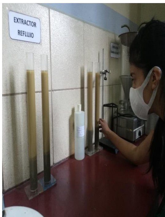
Figura 2.11: Reposo de 5 min de la muestra en Equivalente de arena.
