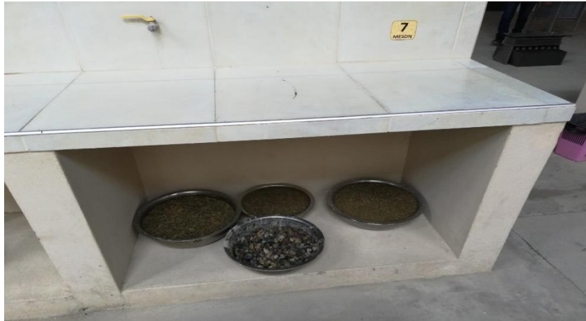
Figura 2.5: Saturado total de grava y gravilla para peso específico.
