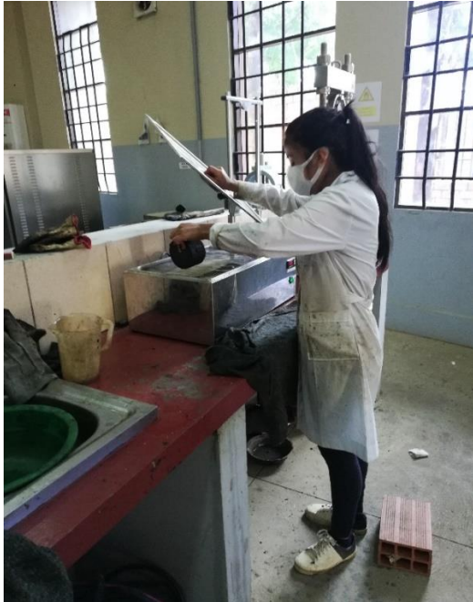
Figura 6.5: Sumergido de briquetas por 30 min a 60°C.
