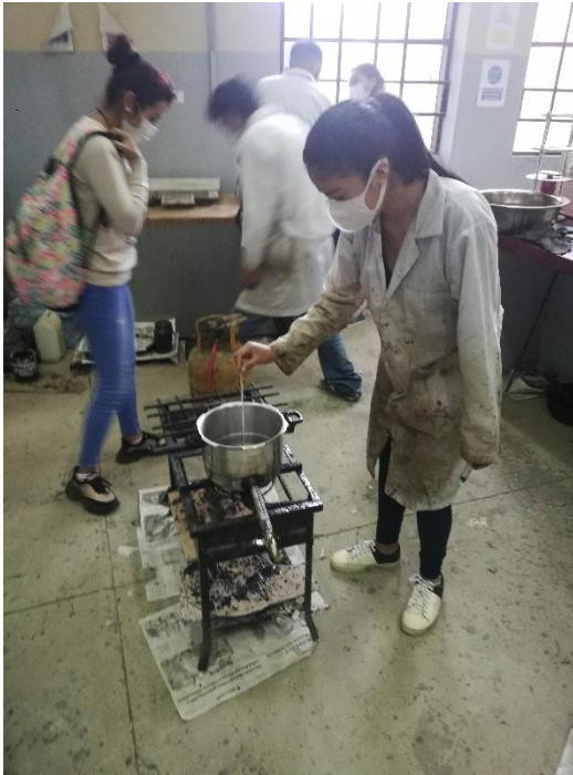
Figura 5.1: Lectura de temperatura del Asfalto.
