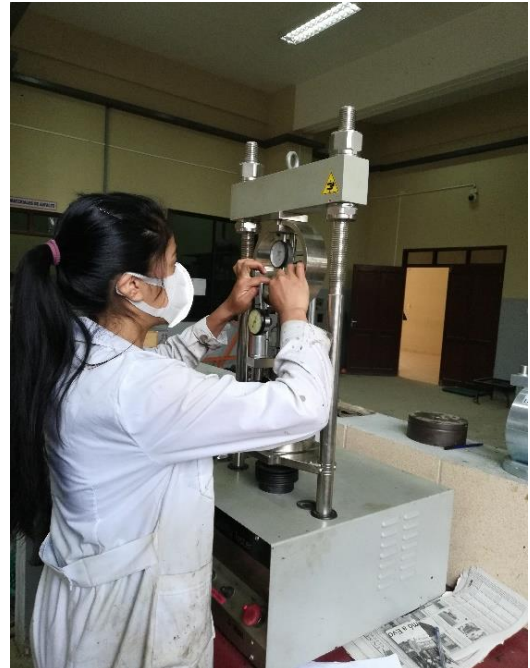
Figura 6.6: Calibración del Equipo Marshall.
