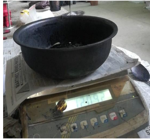
Figura 4.2: Peso de mezcla para Briqueta.
