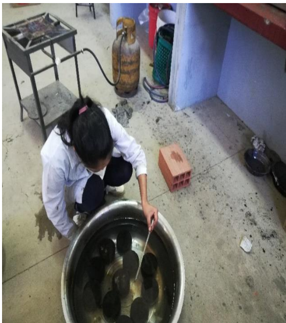
Figura 6.3: Sumergido en agua por 5 min a 25°C.
