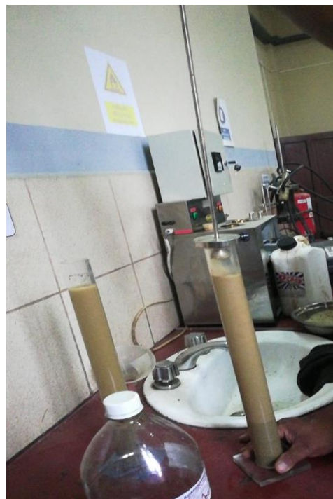
Figura 2.12: Extracción de vacíos para el Equivalente de arena.
