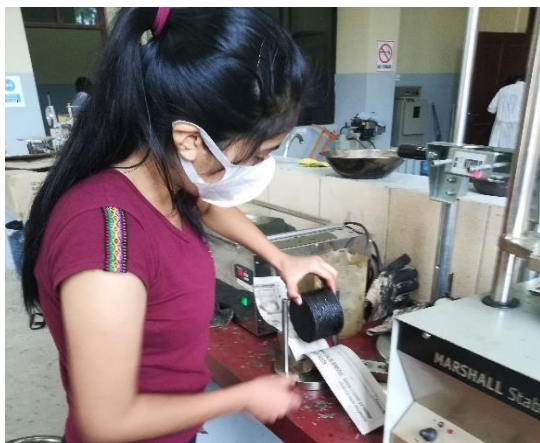
Figura 4.5: Ajuste para rotura en Marshall.
