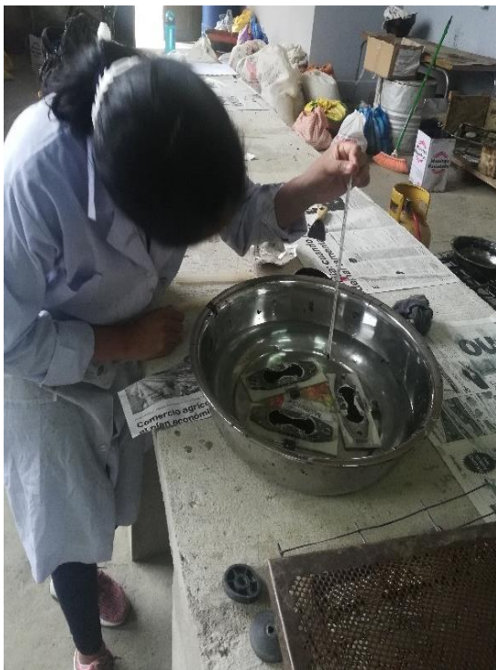
Figura 3.5: Toma de temperatura Ductilidad. Ductilidad
