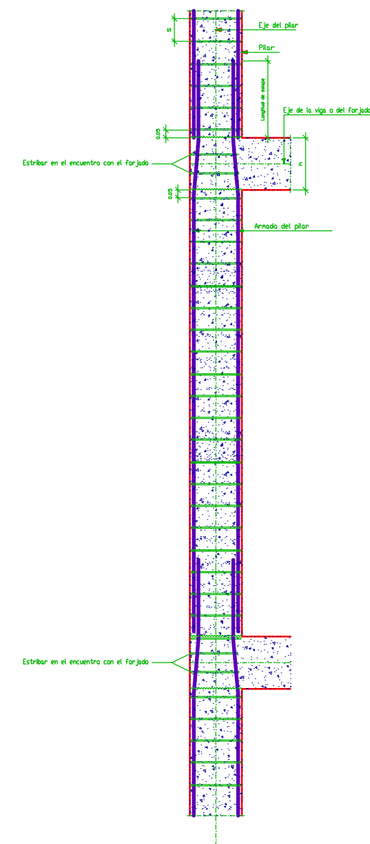
Detalle de estribado de pilares
