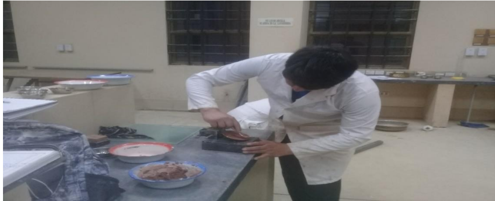
Figura: Determinación del límite líquido
